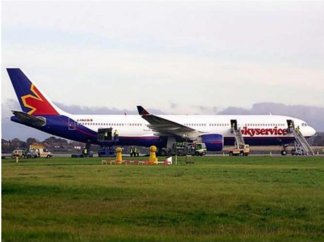
3. 行動計畫：發出飛航公告，報告位置在 06L 起飛，24R 落地使用的跑道距離將縮短。旅客行李移出，燃料抽出，放置用於飛機恢復移動的金屬軌道，由於引擎非常靠近滑行道，因此需要非常小心，移離的 4 小時時間內航機起降持續，未受影響。
