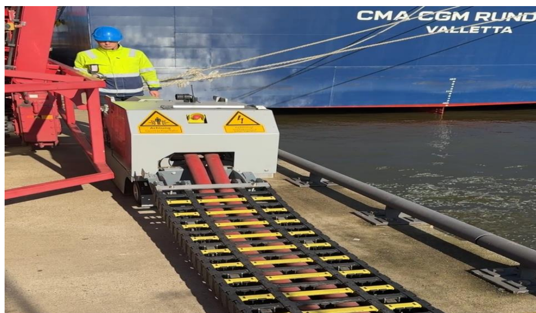
【圖 17、自走式插座車拖帶著電纜拖鏈配合船舶位置移動】
