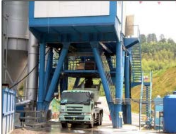
A. 混凝土材料裝車
