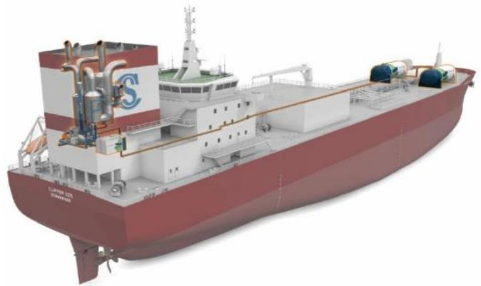
圖表 30 Clipper Eris 碳捕捉及儲存系統
