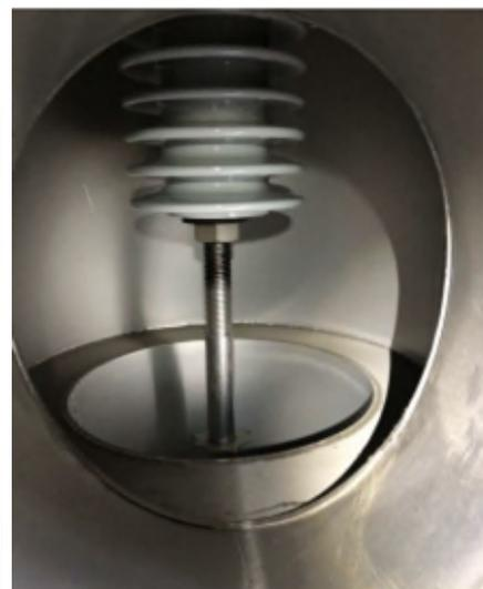
圖 31. Hot Roof 絕緣礙子室
