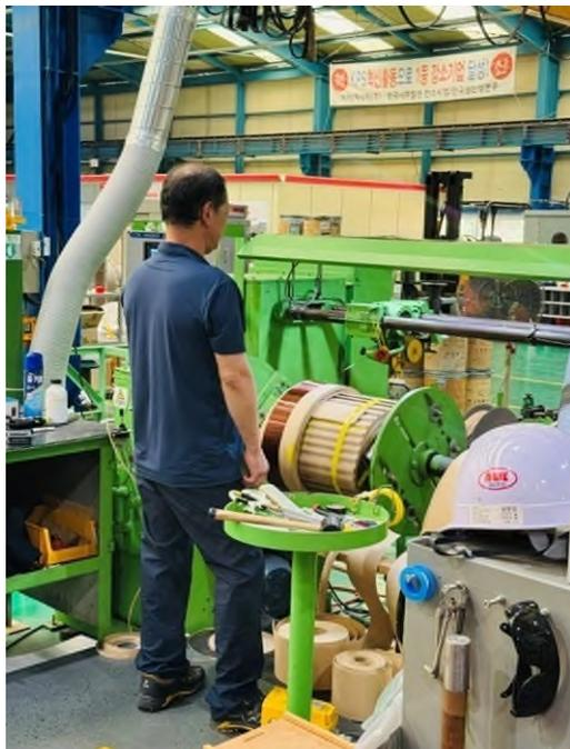
圖 44. 變壓器線圈繞圈作業
