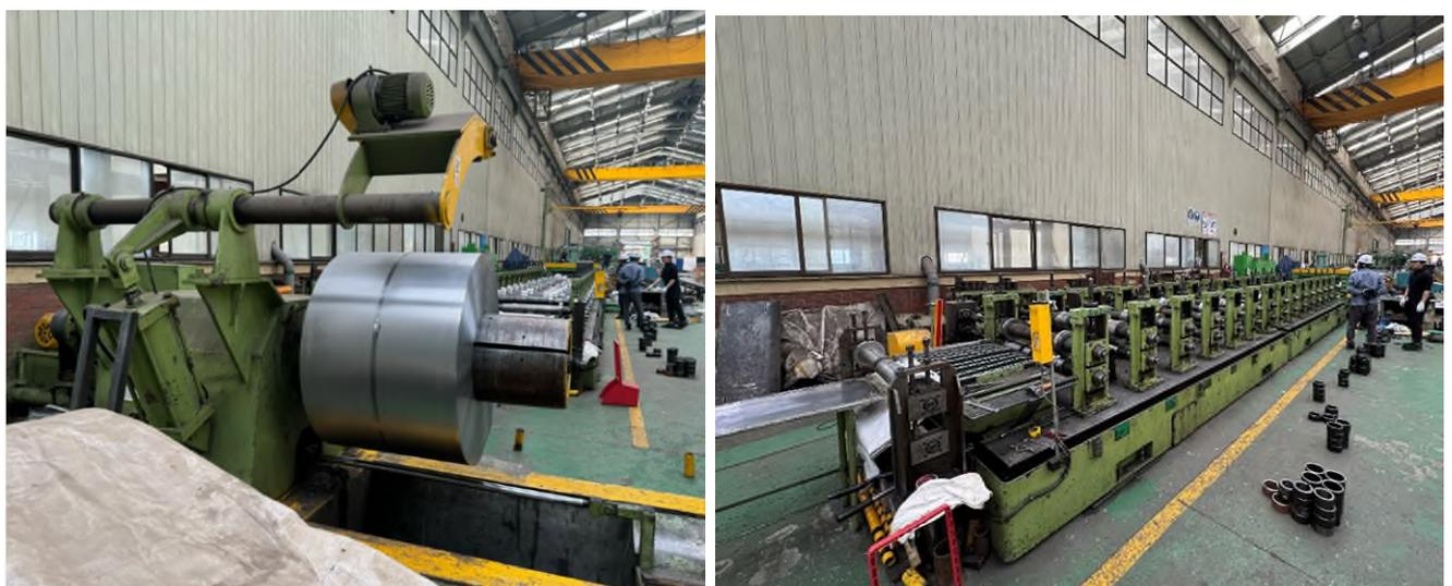
圖 41. 極板滾壓成型作業
