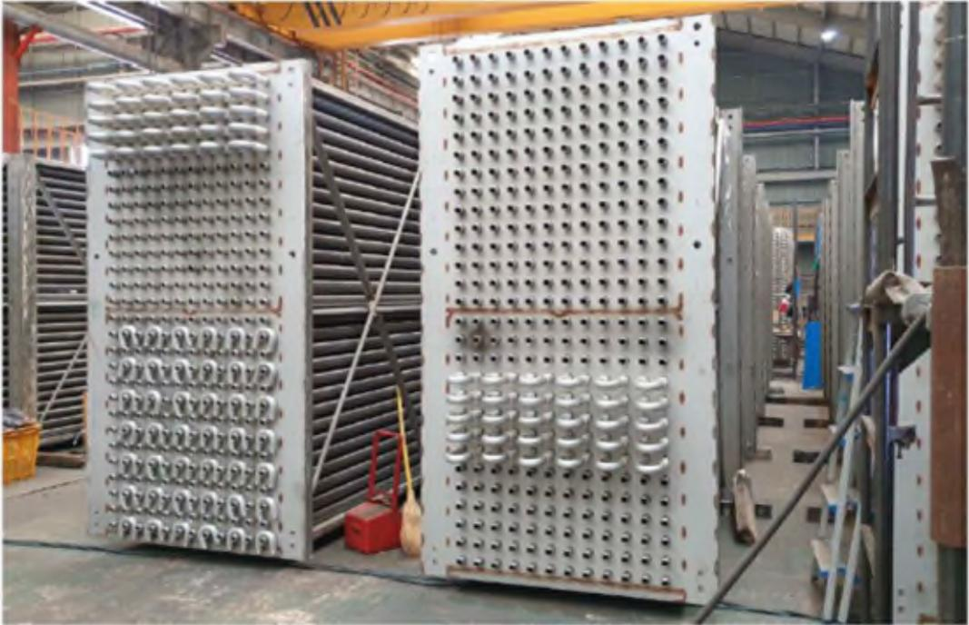
圖 22. U 型管焊接至鰭管上
