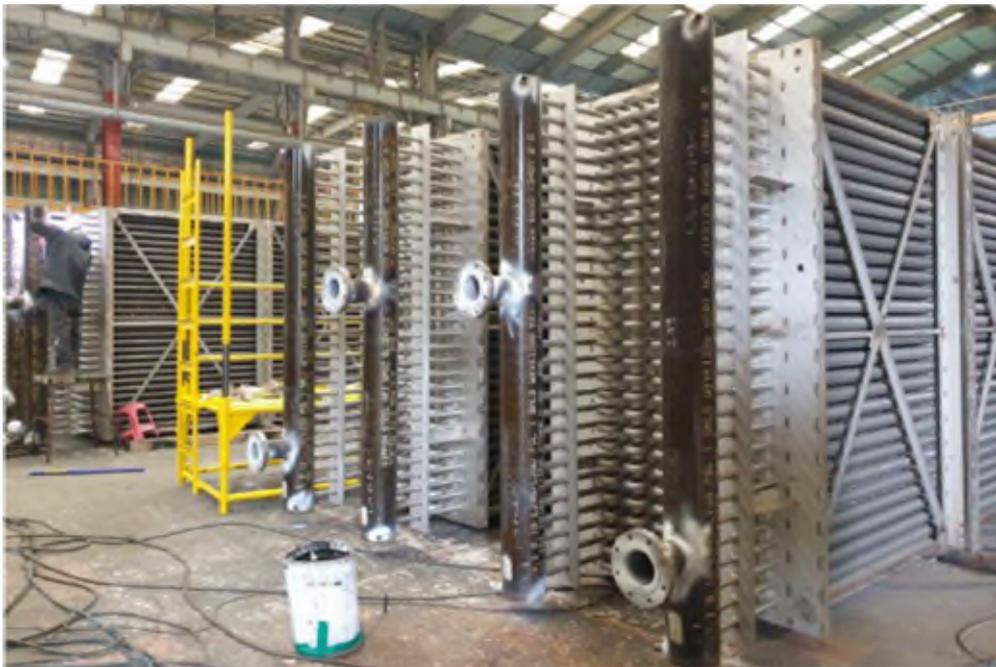
圖 23. 將集管箱組件焊接至鰭管上
