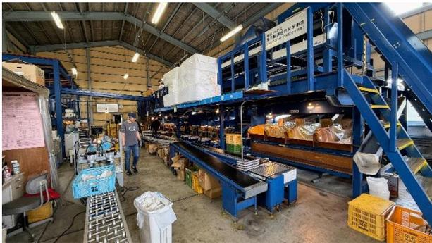
圖 21、由政府補助購置的大型水果選別機
