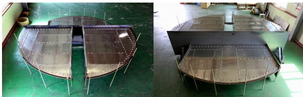
圖 2-6 組裝完成的間隔板塔盤
