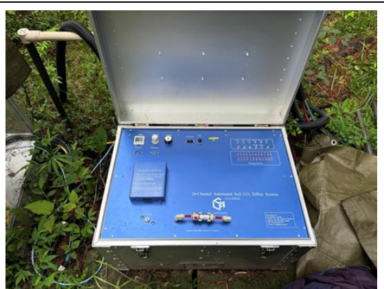
富士山北麓實驗林 Automated Chamber System 主機
