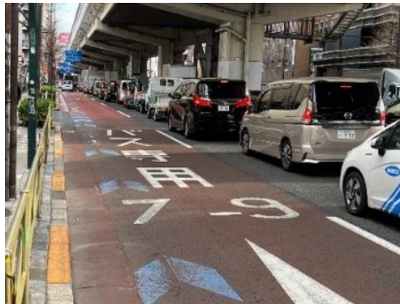
圖2-8-6 利用公車專用道左側設置自行車標誌
