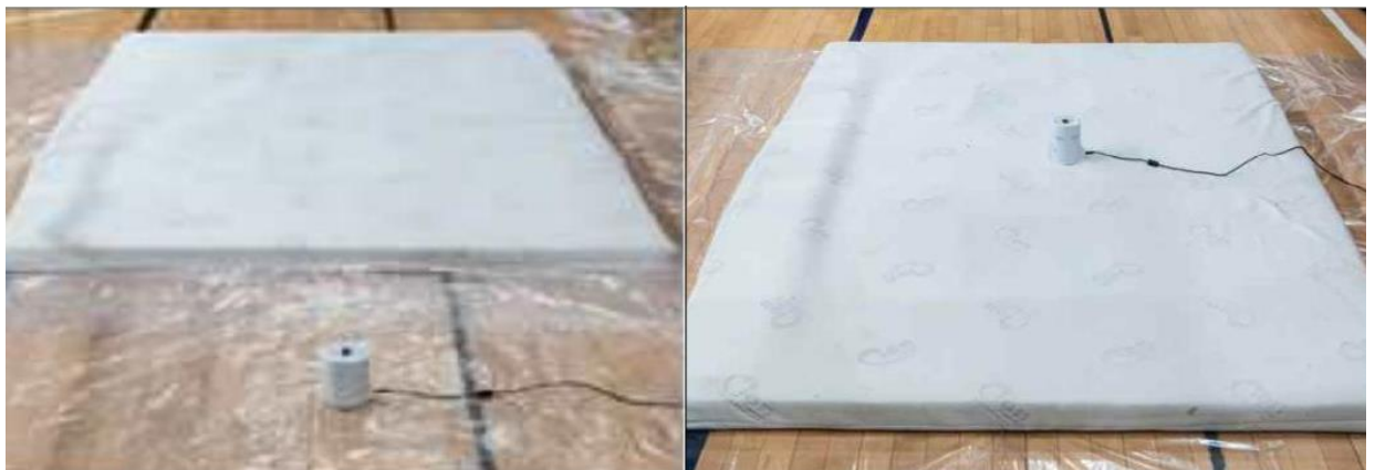
圖11 測量環境背景值(左)及測量待測商品(右)之氡氣量測儀相對位置(資料來源：KINS 網站)
