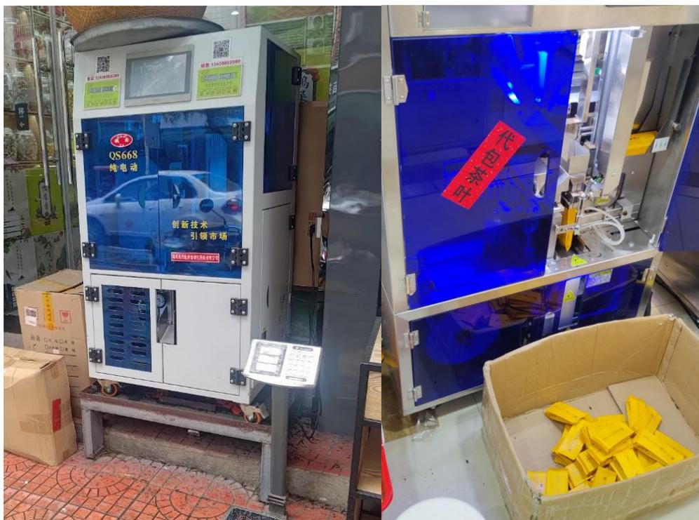
圖七、小包裝之自動茶葉分裝機非常常見，約 8 秒完成一包茶葉分裝，依照機型不同具有包裝整形、抽真空及列印日期等功能，售價折合台幣約 15-20 萬元。
