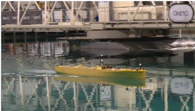
圖 2、靜水性能試驗過程，船速 12 節
