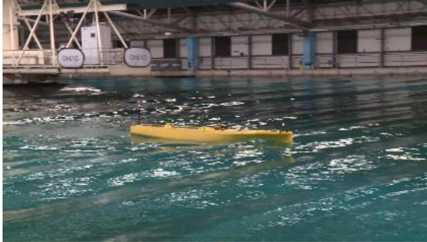
圖 4、蒲氏風力 7 級、船速 12 節之頂浪耐海性能試驗過程
