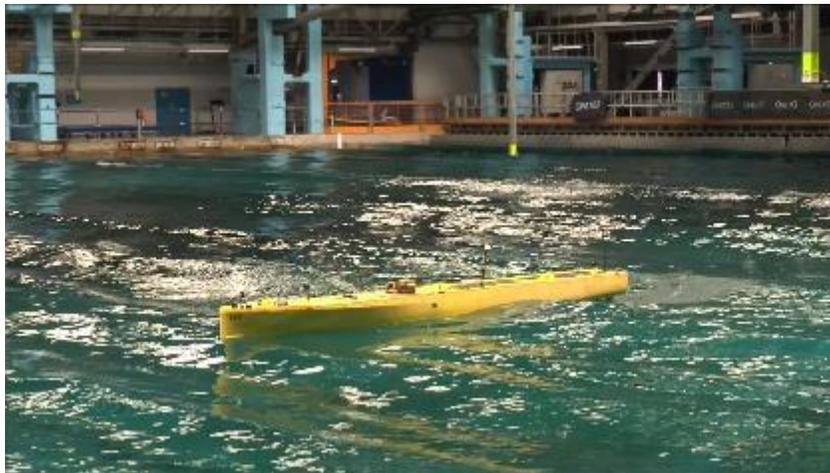
圖 10、蒲氏風力 10 級、船速 18 節之隨浪耐海性能試驗過程
