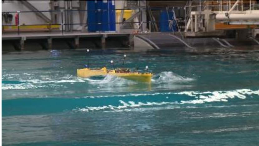
圖 6、蒲氏風力 10 級、船速 12 節之頂浪耐海性能試驗過程
