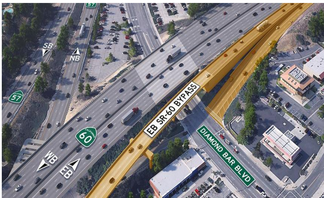
圖八 增設北側系統交流道主線車道，供東行 SR-60 通行(跨 Diamond Bar Blvd.)
