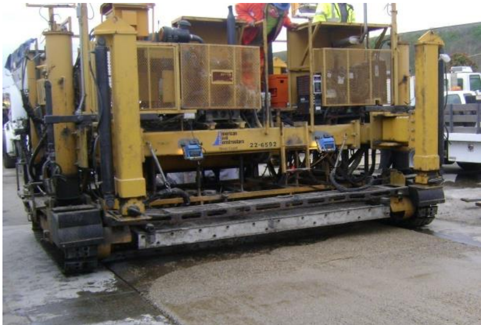
圖二十九 聚酯混凝土鋪裝機
