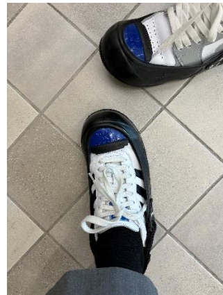
圖 47、工作保護鞋(保護前腳趾，設計採前端硬厚，可快速套上) (自行拍攝)
