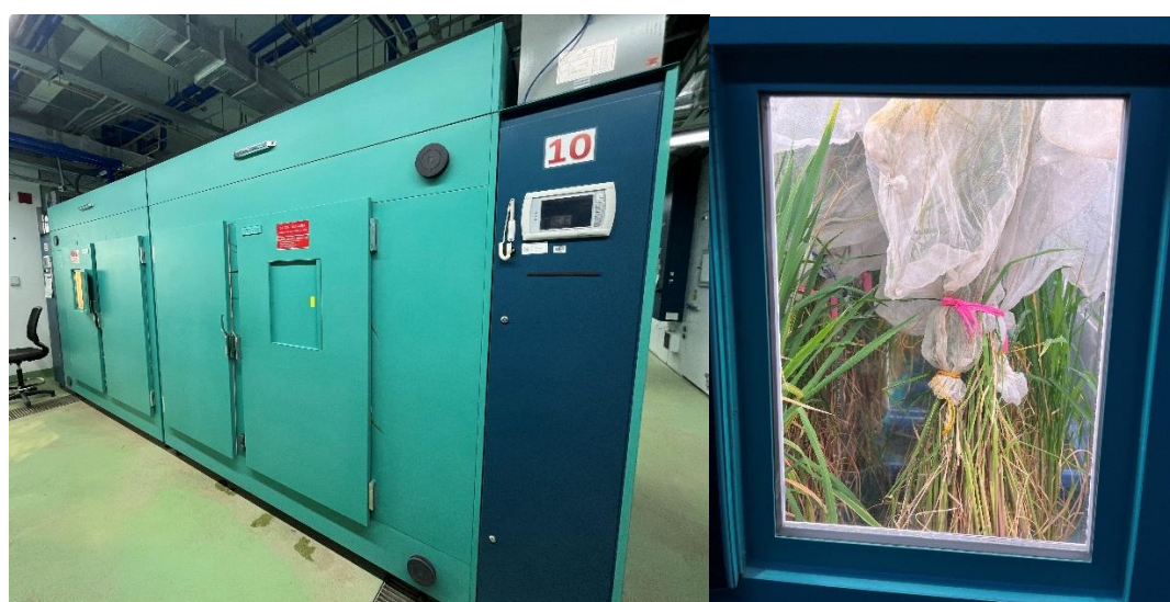
圖 10、SBF 的走入式生長箱亦可調控溫度、光照、濕度及二氧化碳含量等
