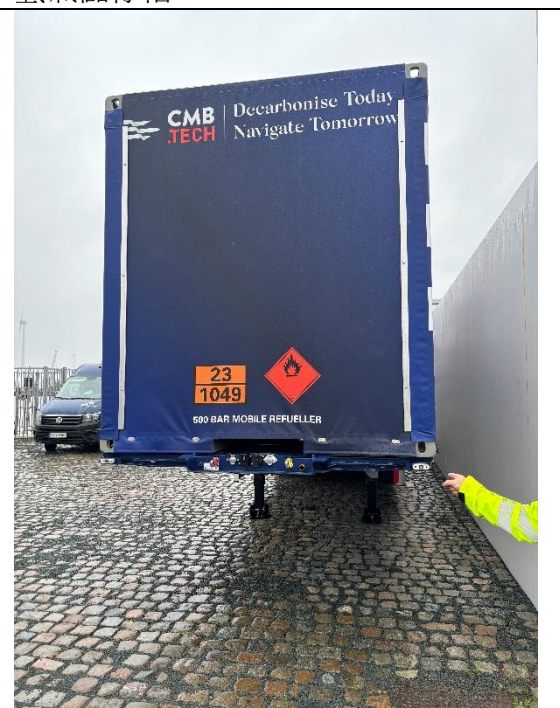
移動式加氫卡車可幫船舶補給
