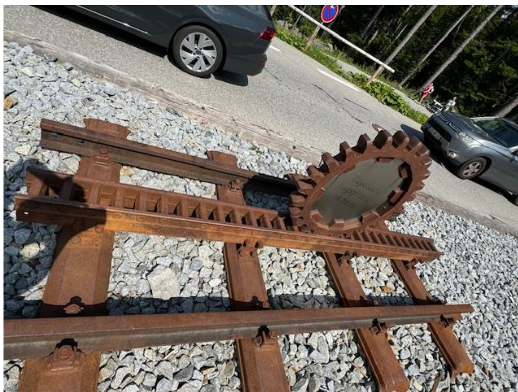
圖 2.3-5 齒軌鐵路結構
