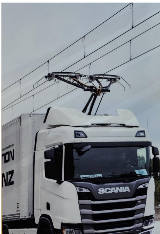
圖 2.2-11 電車線提供電力經車頂集電弓提供電動馬達之動力源
