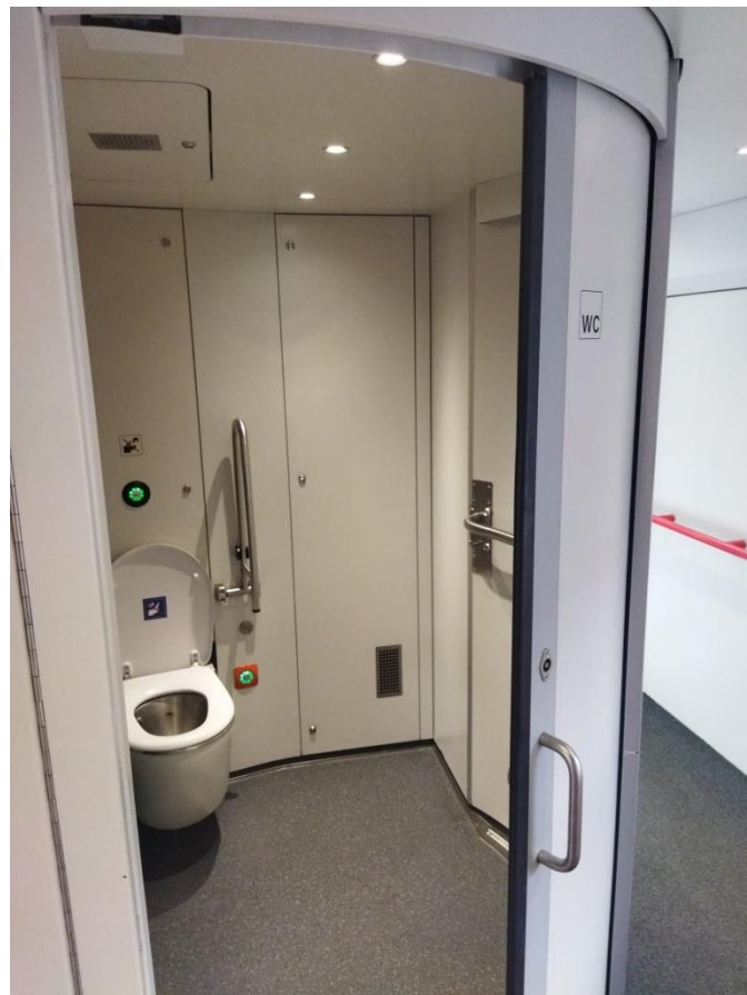
無障礙廁所，使用弧形門，手動開關門
