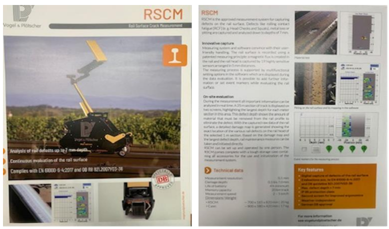
RSCM 鋼軌表面裂紋測量系統
