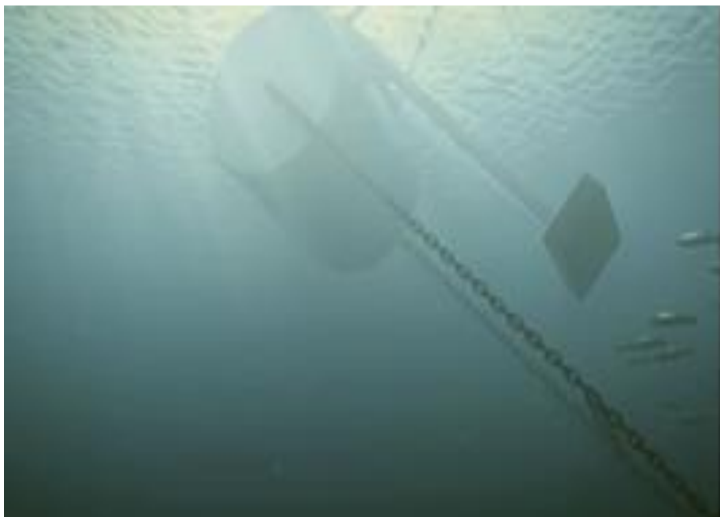
圖 13 浮桶式浮標固定在海底
