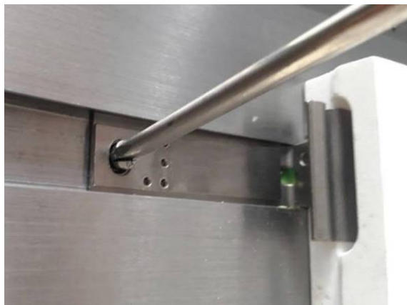
圖十三、使用一字起子將定位銷一字開槽端的尖頭撐開
