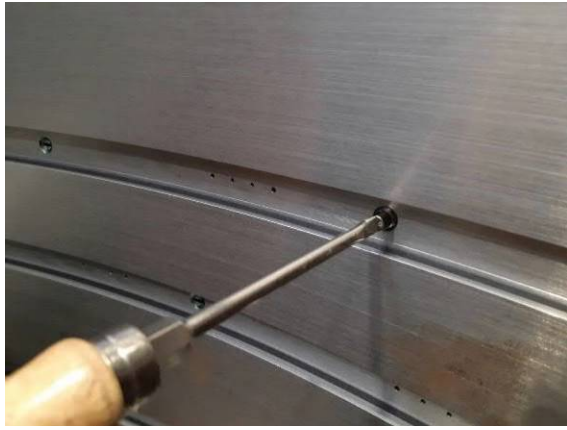
圖三、定位銷尖端不要突出示意圖
