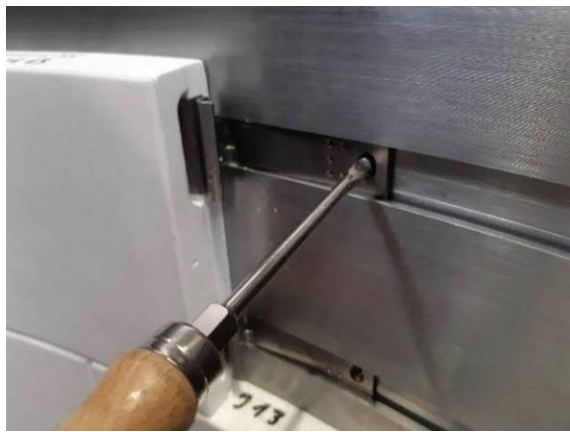
圖十一、定位銷旋出直到碰到耐火磚支撐架尾端孔口
