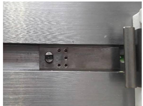
圖十四、定位銷一字開槽端的尖頭撐開後示意圖
