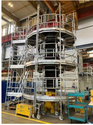
圖九、安裝轉子及動葉直立式專用施工架
