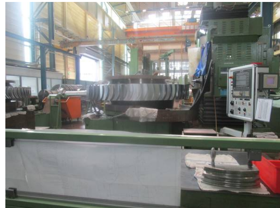
圖二十七、使用成形刀進行葉根槽銑削
