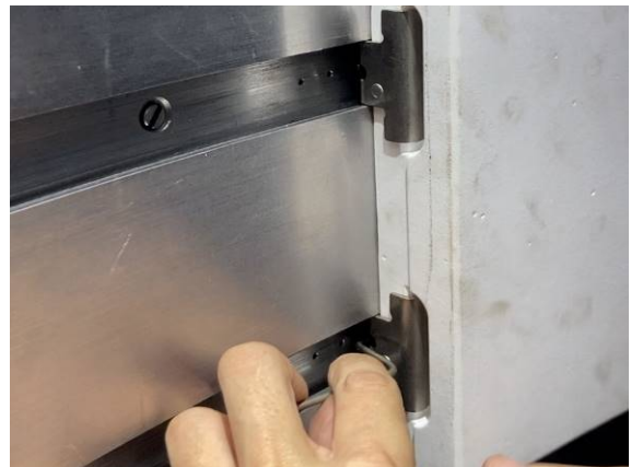
圖八、確認衝擊冷卻空氣孔的開口沒有阻塞
