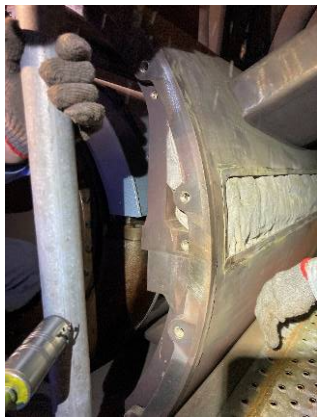
圖十九、SGT6-2000E型更新過後排氣擴散器上蓋襯板變成連起來的位置
