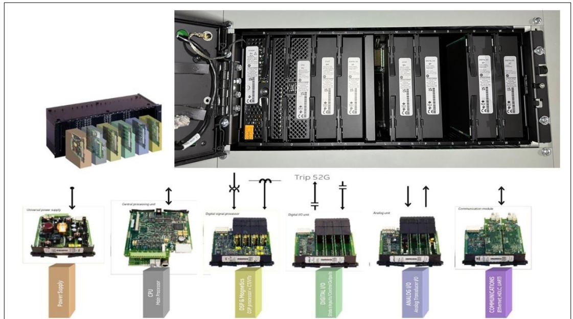
圖 3.2.1.2 發電機保護電驛 G60 模組排列
