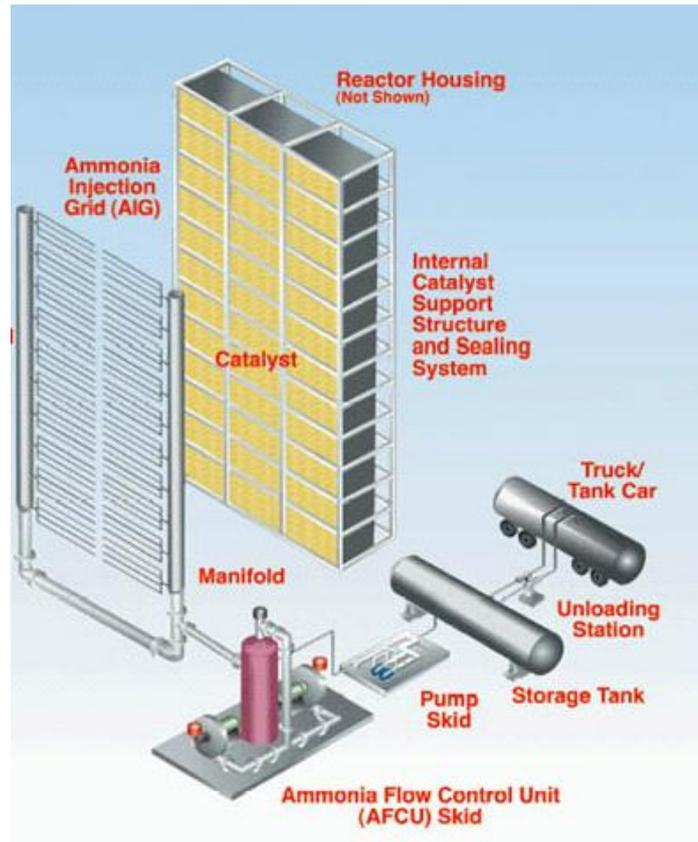
圖 19 SCR 系統組成設備
