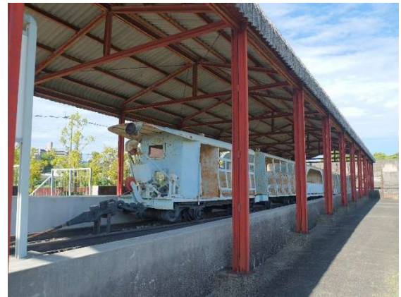
於斜坑內載運作業人員用的機車
