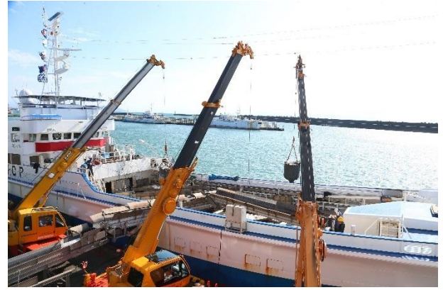
圖 32. 日本燒津漁業洋漁船卸魚「魚體不落地」作業情形-冷凍魚貨直接以機械化方式配合輸送帶運往冷凍卡車裝填(1)。
