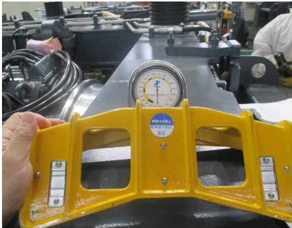
圖3-7-1 車輪直徑量測工具
