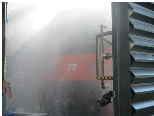
圖3-8-8 現場後端水密測試
