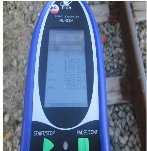
圖3-6-9 後端低音汽笛噪音值
