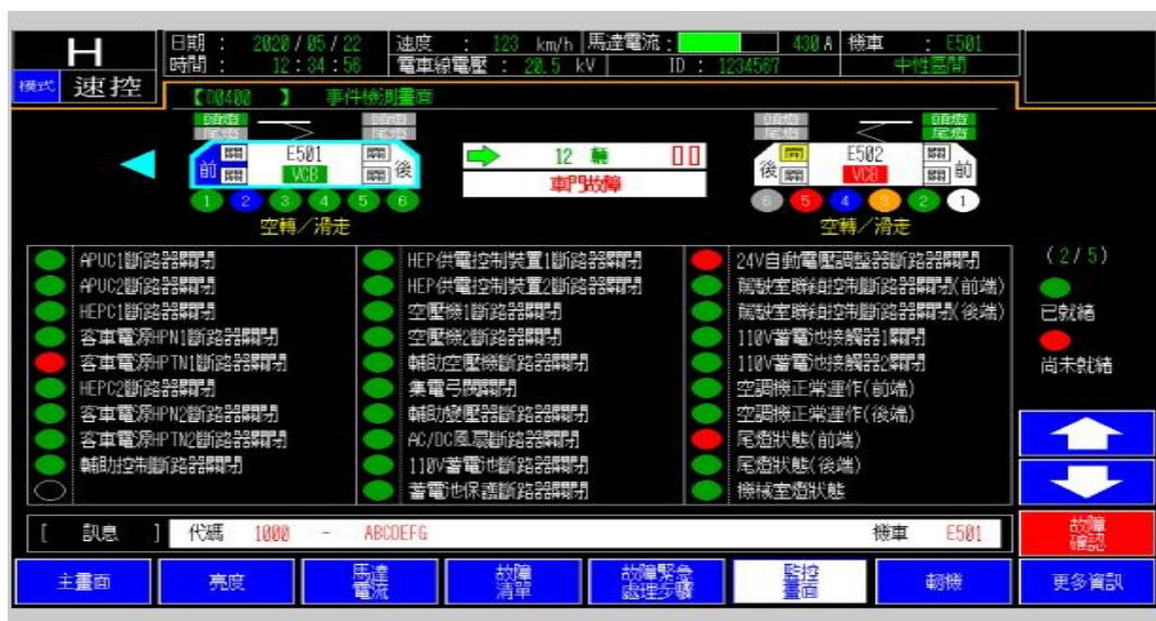
圖 6-15 E500 型 LCMS 駕駛顯示器事件檢測畫面示意圖
