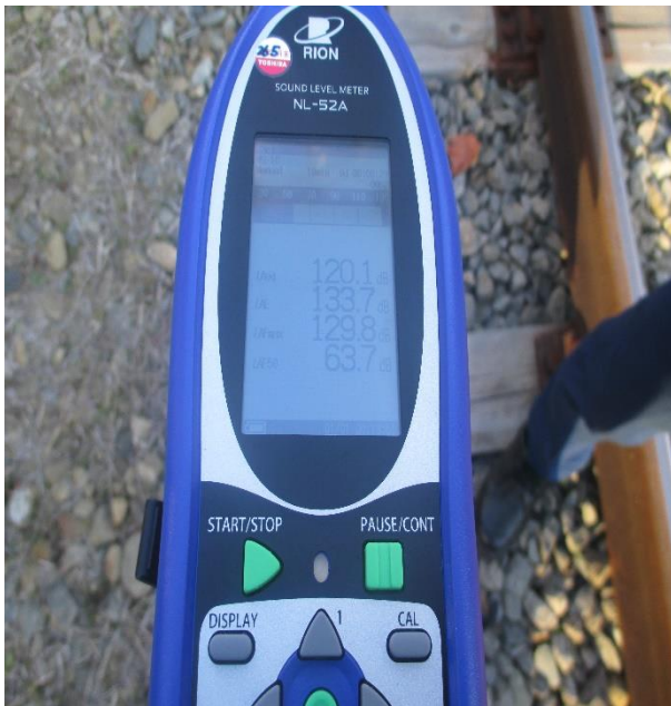
圖3-6-8 後端高音汽笛噪音值
