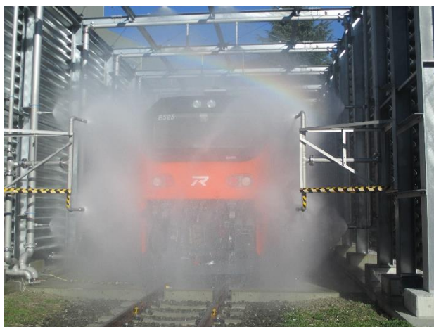
圖3-8-7 現場前端水密測試
