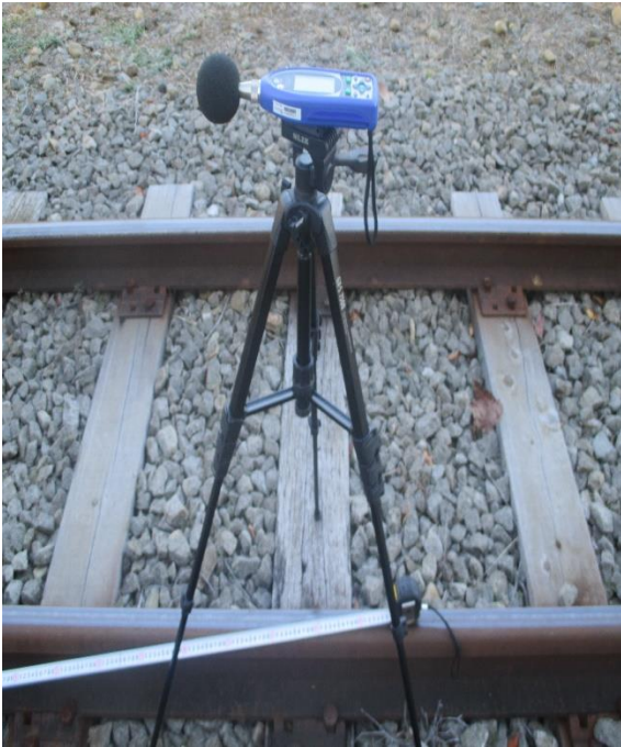
圖3-6-2 現場噪音計架設(1)
