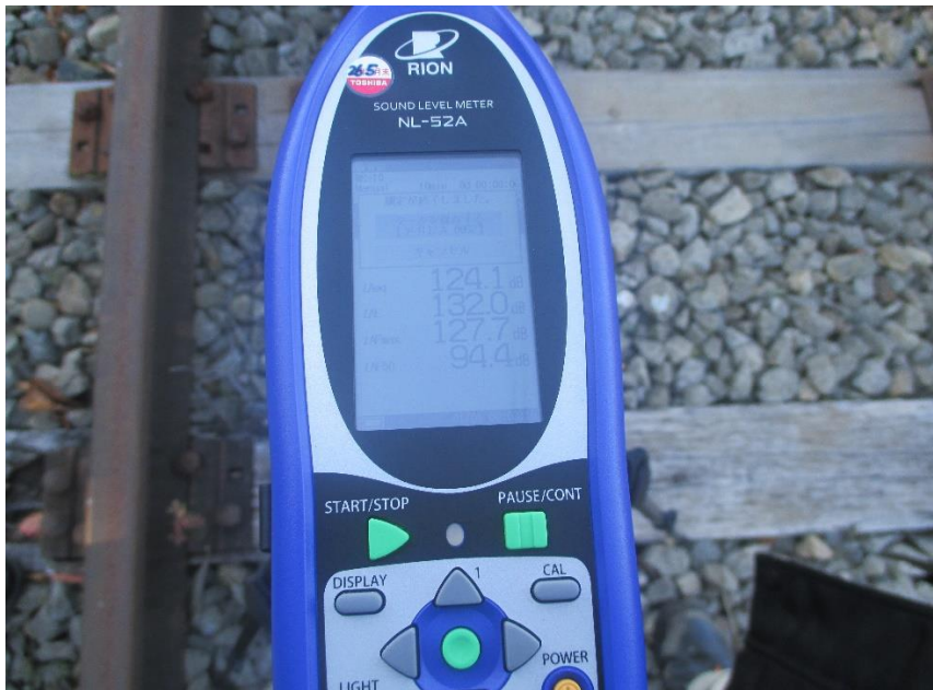
圖3-6-1 現場測試用噪音計實拍
