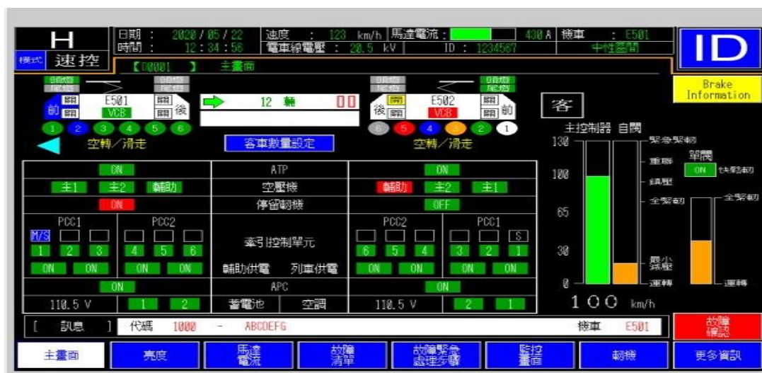
圖 6-12 E500 型 LCMS 駕駛顯示器主畫面示意圖
