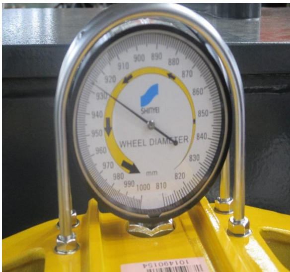
圖3-7-8 現場車輪直徑量測
