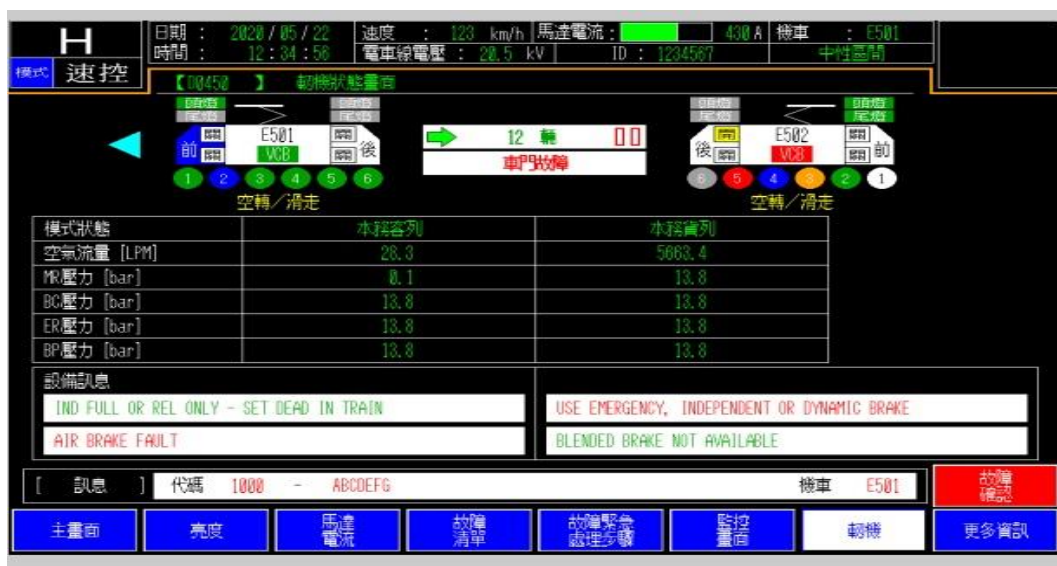
圖 6-14 E500 型 LCMS 駕駛顯示器轉機狀態畫面示意圖
