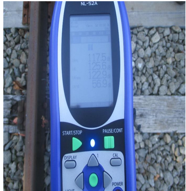
圖3-6-7 前端低音汽笛噪音值
