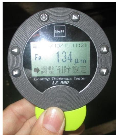
圖 3-2-17 車架量測結果
