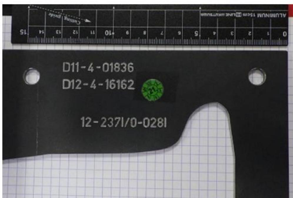
圖 3-2-48 車輪踏面輪廓確認量具
