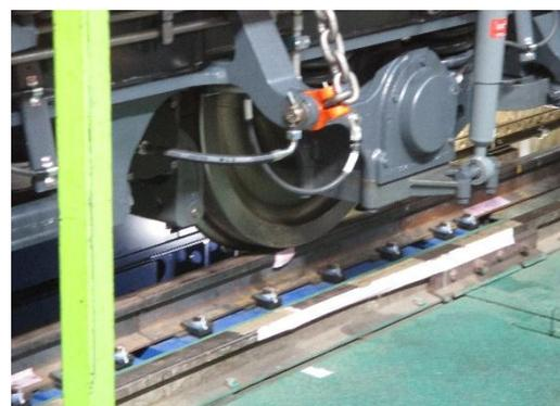
圖 3-2-107 軸重量測中
