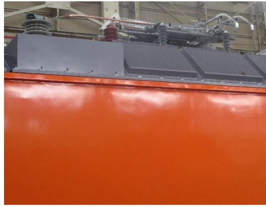
圖 3-1-9 車頂高壓設備組裝
