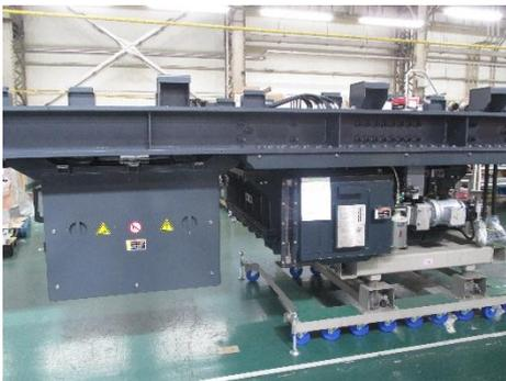
圖 3-1-1 車架下方設備組裝
