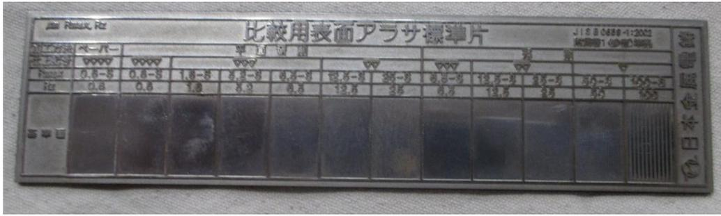
圖 3-2-121 車輪踏面粗糙度標準片
