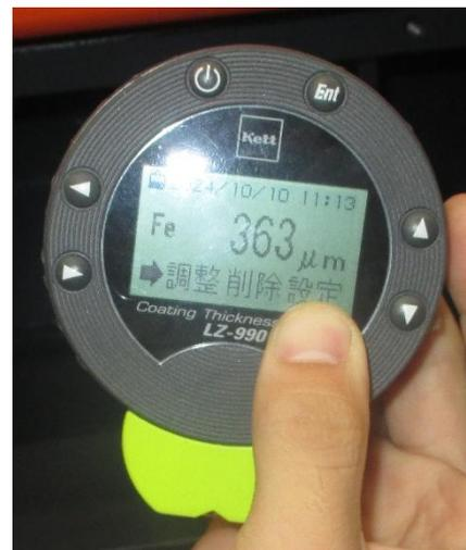
圖 3-2-11 機械式側牆量測結果
