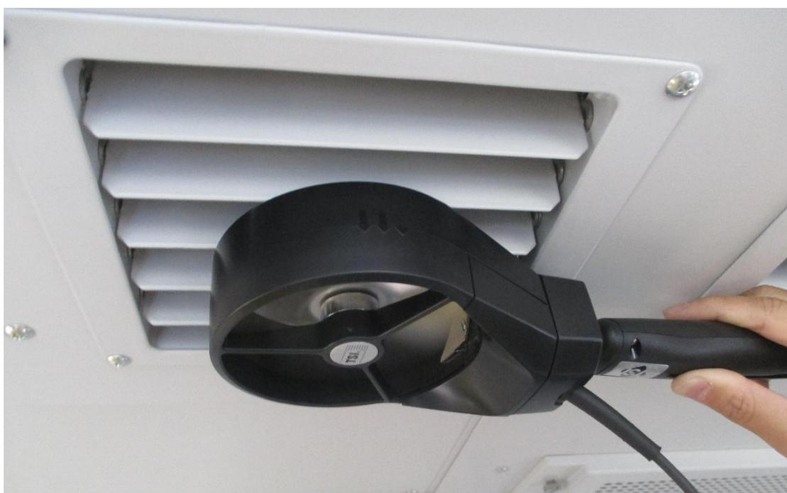
圖 3-2-68 冷氣出風口流量量測
