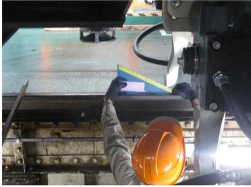
圖 3-2-115 輔排高度量測
