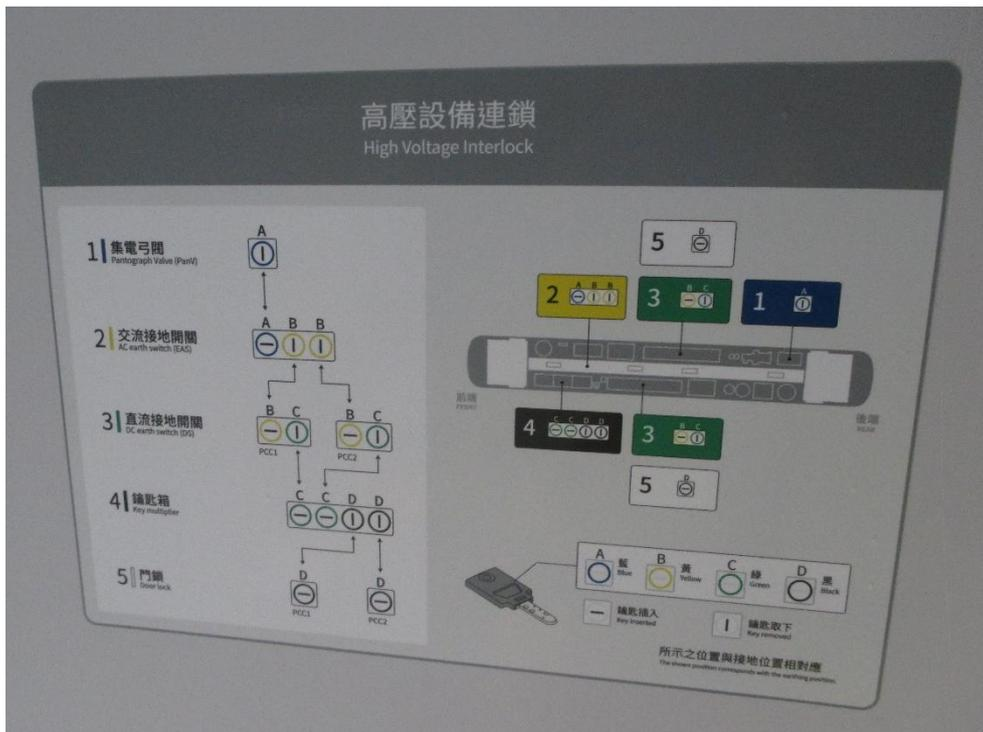
圖 5-24 高壓設備連鎖解除圖示
