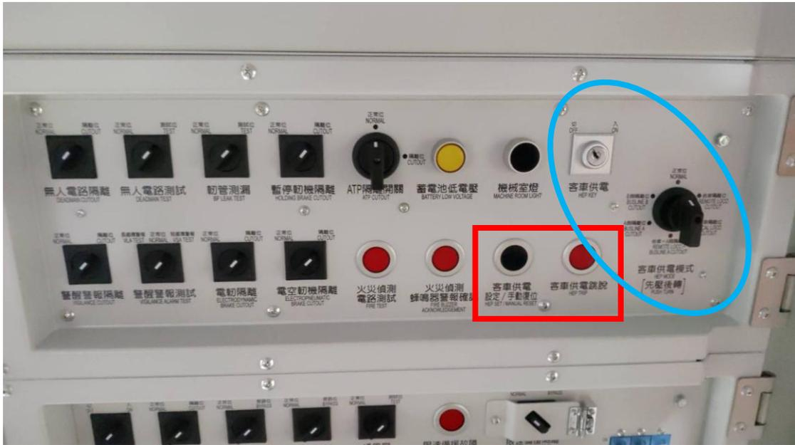
圖 5-17 客車送電操作區域(藍圈內的為供電模式選擇開關)
