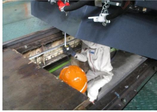
圖 3-2-116 主排高度量測
