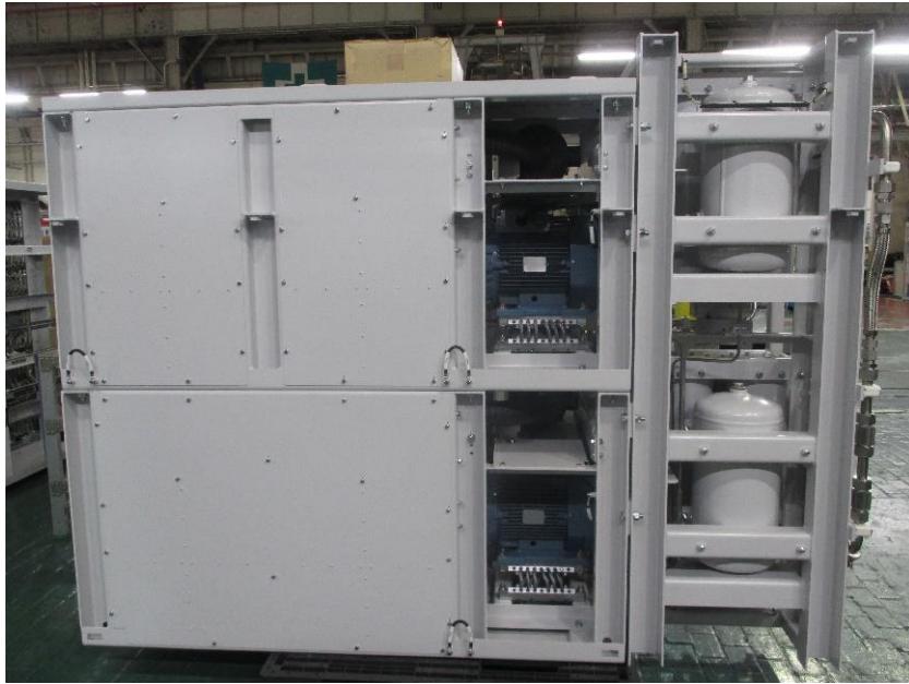
圖 7-5-2 空氣壓縮機與空氣乾燥器背面
