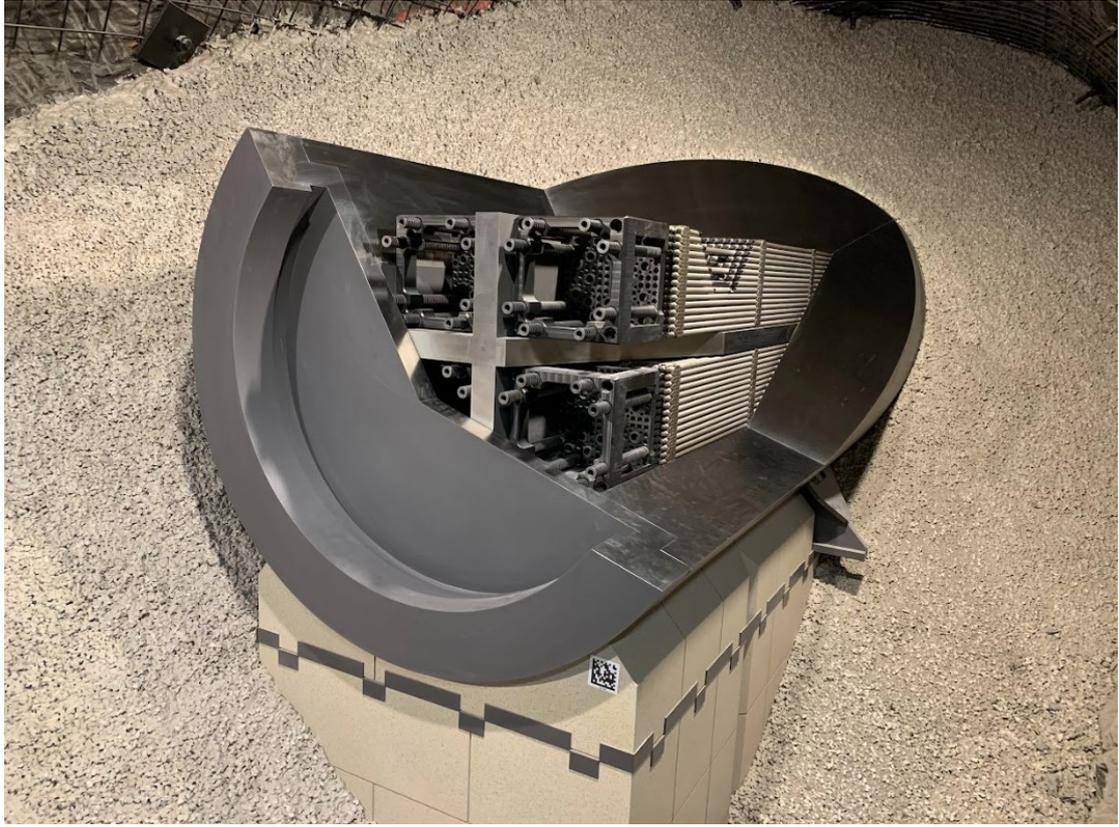
圖 3：Mont Terri 岩石實驗室現場之工程障壁示意模型
