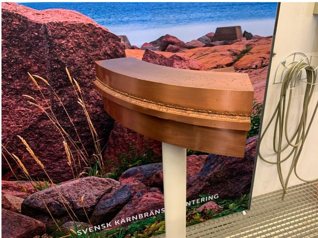
圖 37：電子束焊接之焊道較粗糙
