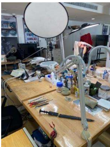
正在執行的青銅斷劍修復與相關修復設備、材料
