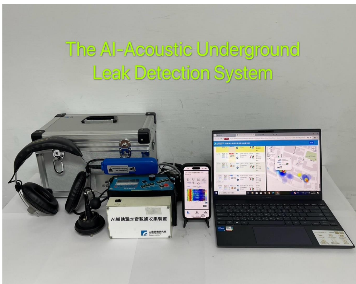
圖 33 台水公司 AI-聲學地下漏水檢測系統設備
