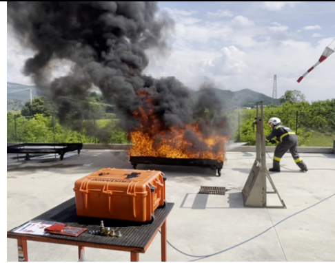
工作人員穿戴消防裝備示範小型攜帶式水霧滅火設備使用方式
