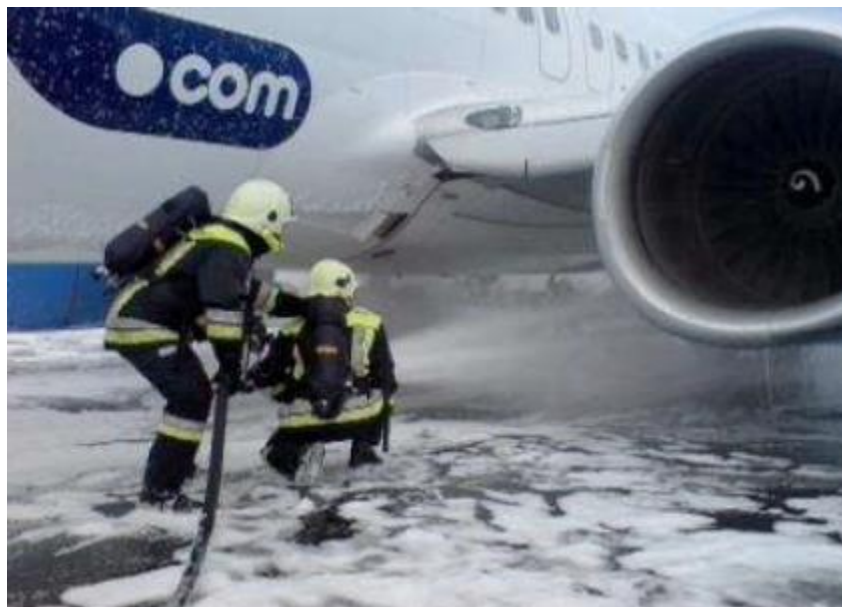
(上圖) 消防泡沫噴灑後可能對發動機造成損害
