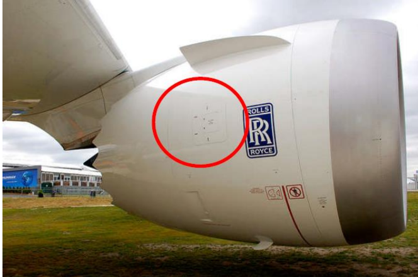
(上圖) 發動機上的消防員面板
