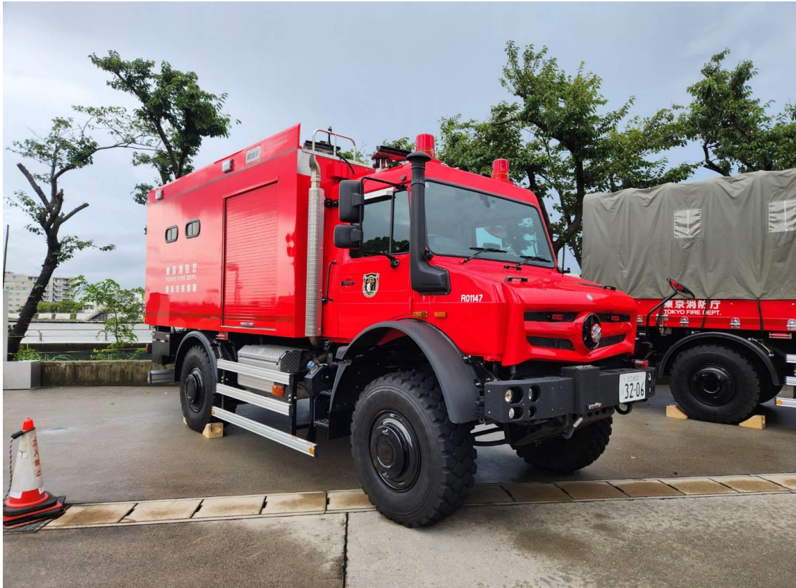
圖 82 強化涉水性能之高機動車輛性能之高機動救援車（硬殼式運輸幫浦車）
