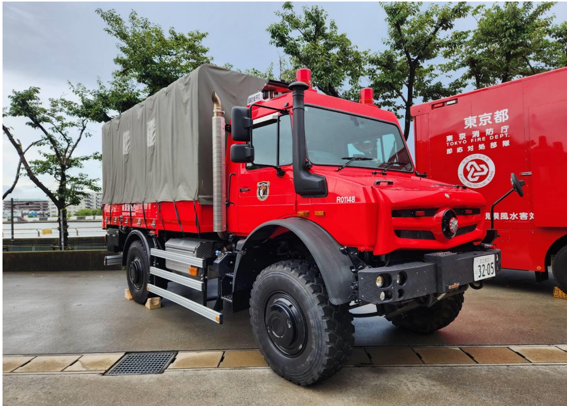
圖 83 強化涉水性能之高機動車輛性能之高機動救援車（軟頂式運輸車）
