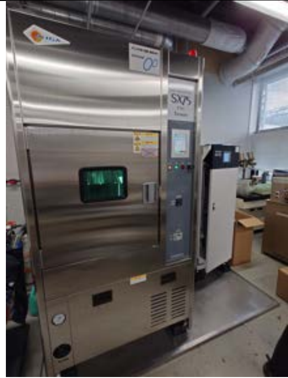
測試漆液耐候相關設備
