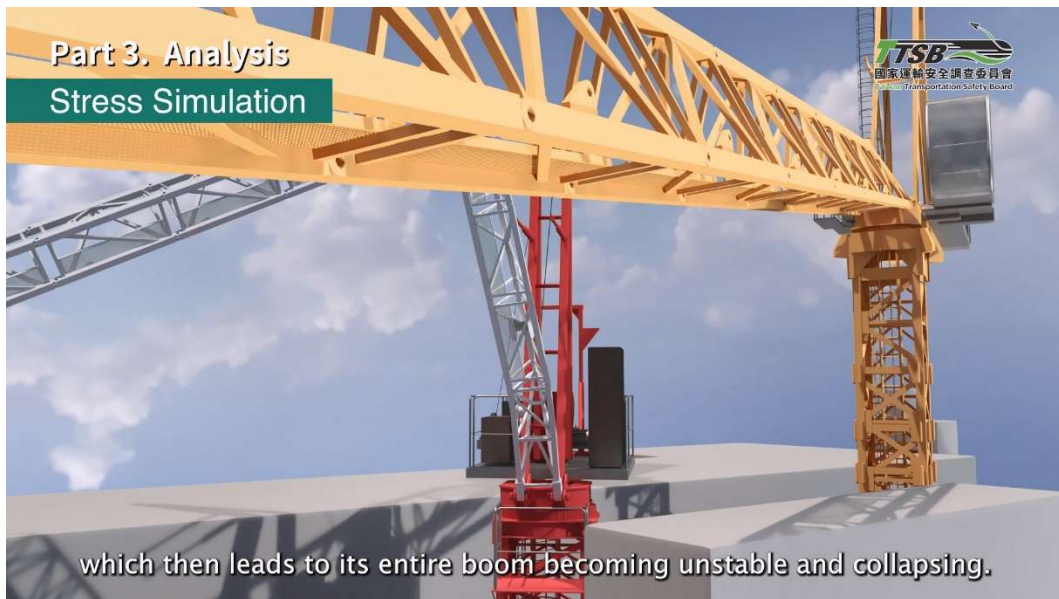
圖 3.5-2 桁架失效模擬動畫之片段
