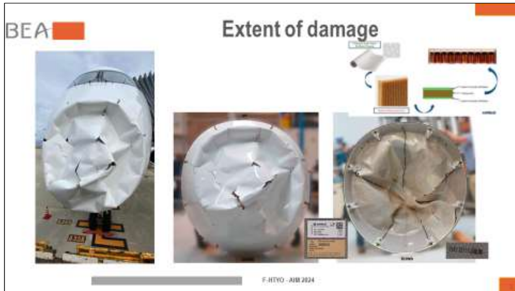
圖 3.2-1 法國 BEA 分享 A350 雷達罩損壞分析案例
