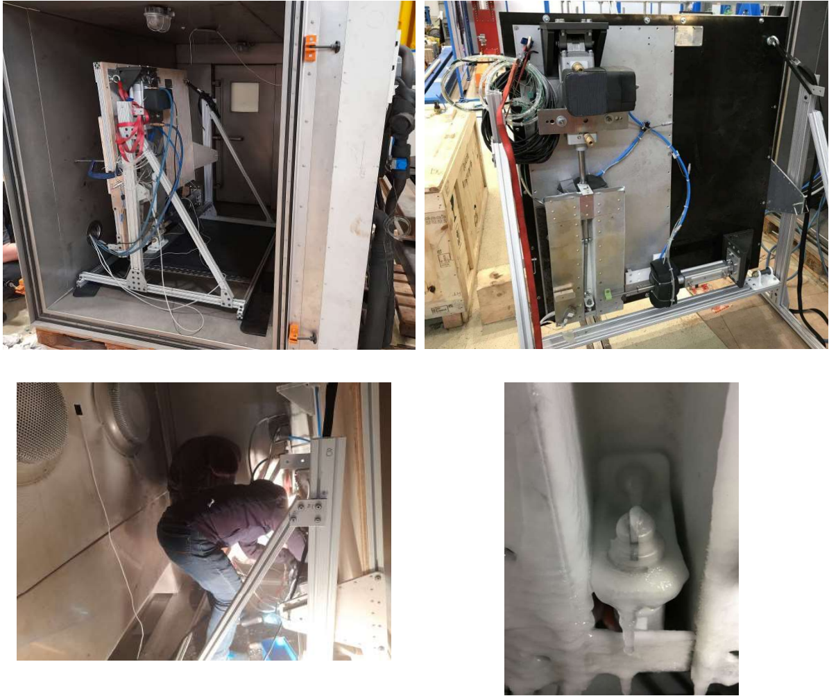
圖 3.4-3 艙門於氣候室進行結冰測試
