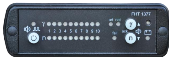
圖 9&10、背負式輻射偵測設備及呈現儀表
