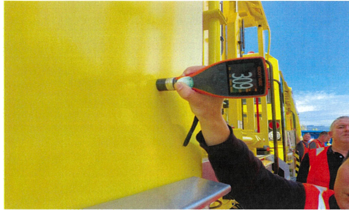
圖 30 大型砸道車塗裝膜厚測試
