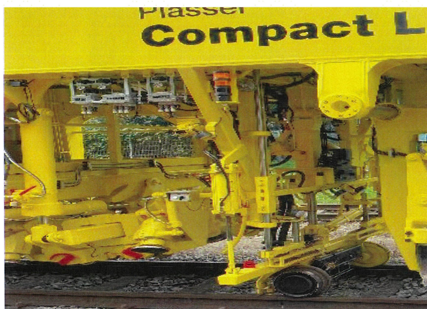
圖 19 大型砸道車測量台車裝置
