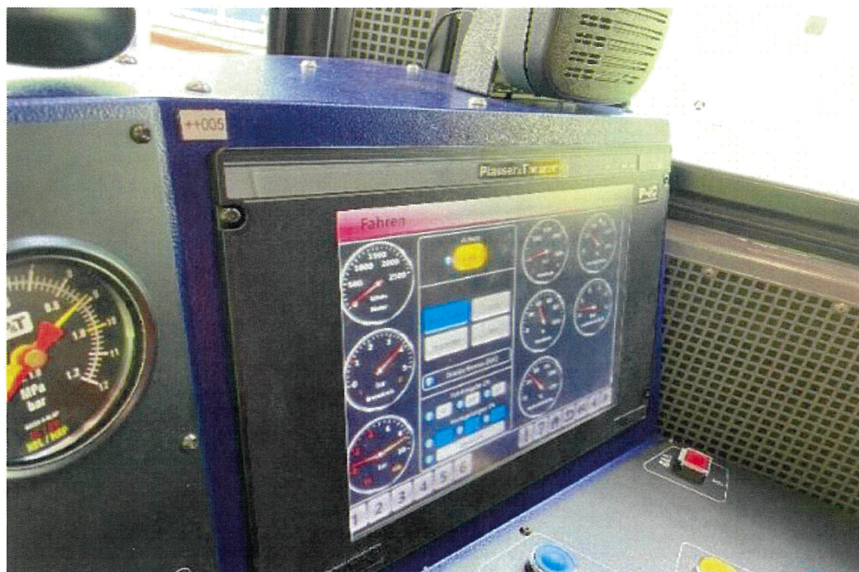
圖 45 大型砸道車確認操作聯掛測試(操作連鎖測試)
