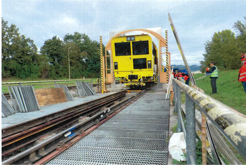
圖 38 大型砸道車車輛通過縮小車輛界限框測試
