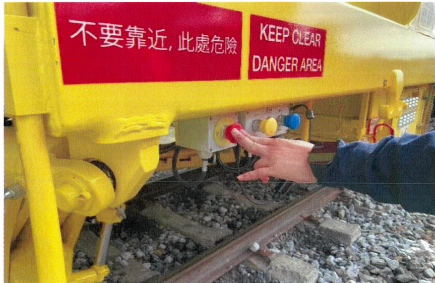
圖 50 大型砸道車緊急按鈕測試
