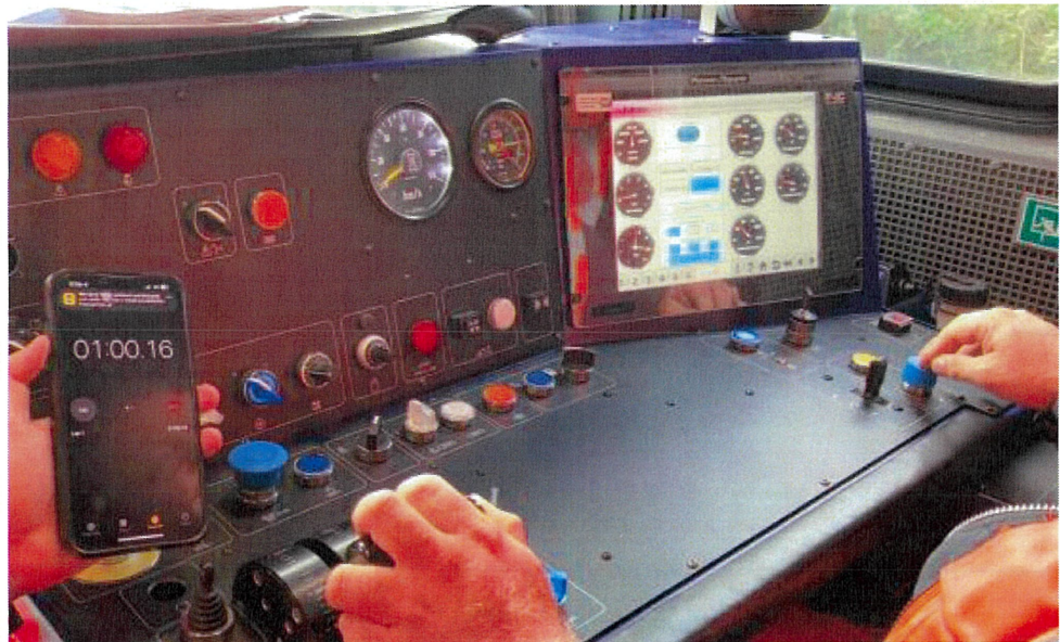
圖 46 大型砸道車連續行使 60 秒測試
