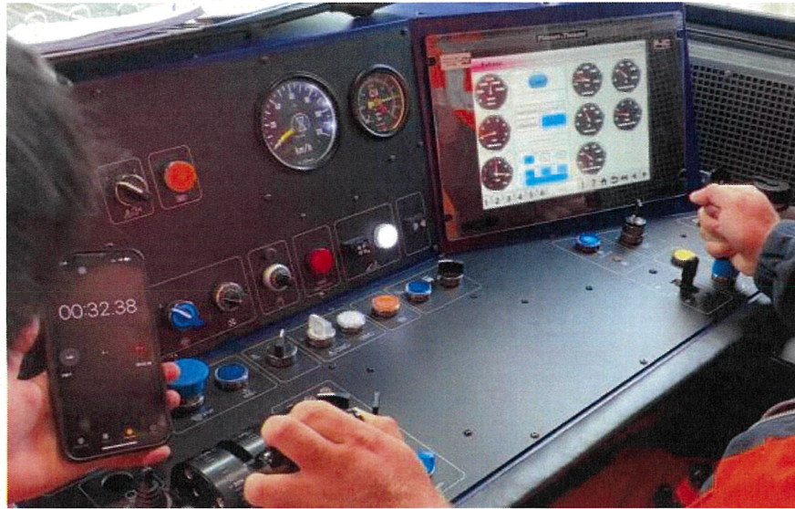
圖 48 大型砸道車按而不釋放警醒裝置紐測試
