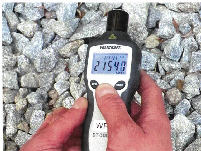
圖 53 大型砸道車振動頻率大於 35Hz 測試
