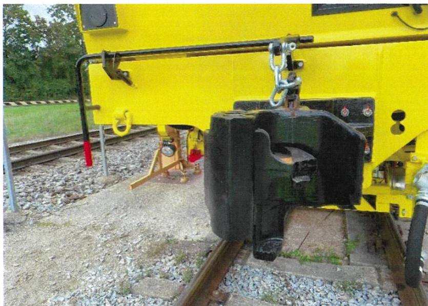
圖 18 大型砸道車連結器裝置
