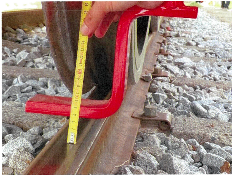
圖 24 大型砸道車輔助排障器
