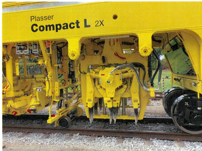
圖 21 大型砸道車之撥道台車及中感觸桿
