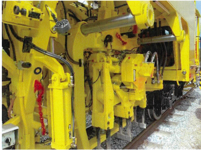
圖 51 大型砸道車單一砸道機構可橫向移動測試
