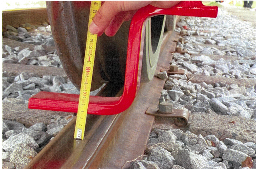
圖 36 大型砸道車輔助排障器量測
