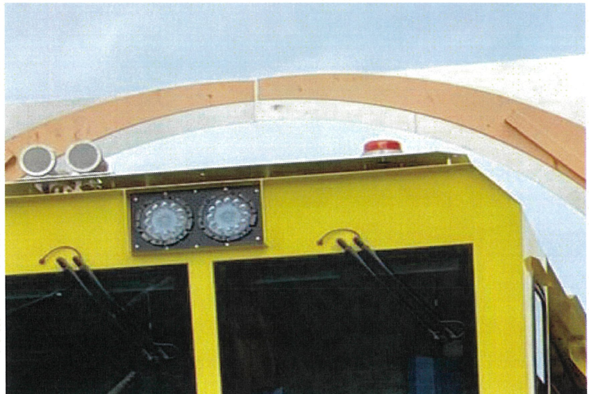
圖 42 大型砸道車車輛前、後端頂部應設置旋轉警示燈
