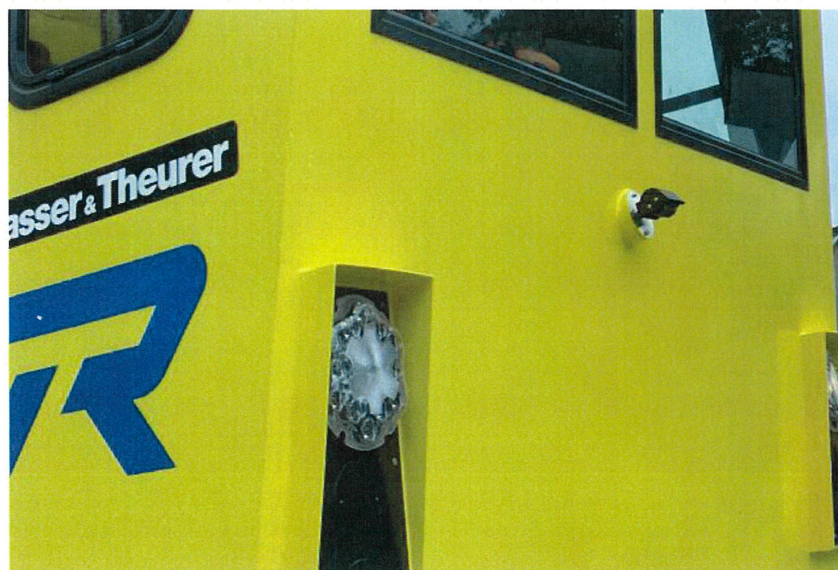
圖 117 軌道穩定車攝影機鏡頭測試
