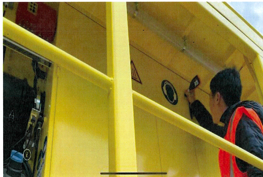
圖 98 軌道穩定車塗裝膜厚測試
