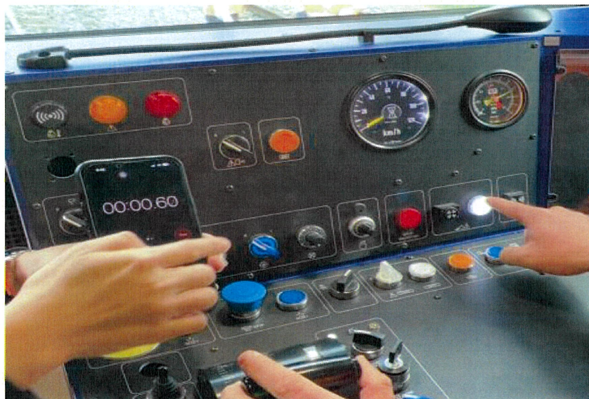
圖 115 軌道穩定車未按警醒裝置紐測試
