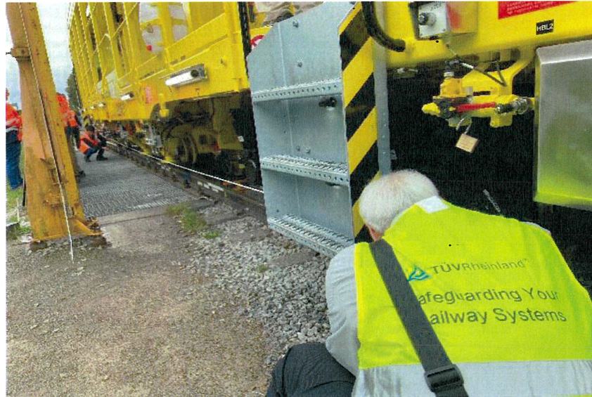
圖 105 軌道穩定車 2 轉向架軸距量測
