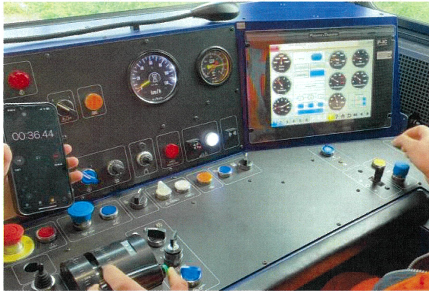
圖 116 軌道穩定車按而不釋放警醒裝置紐測試
