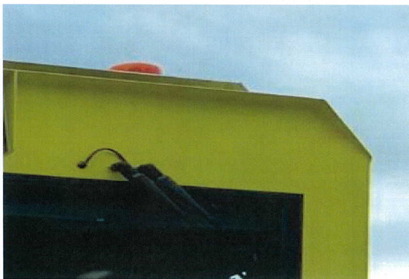
圖 110 軌道穩定車車輛前、後端頂部應設置旋轉警示燈
