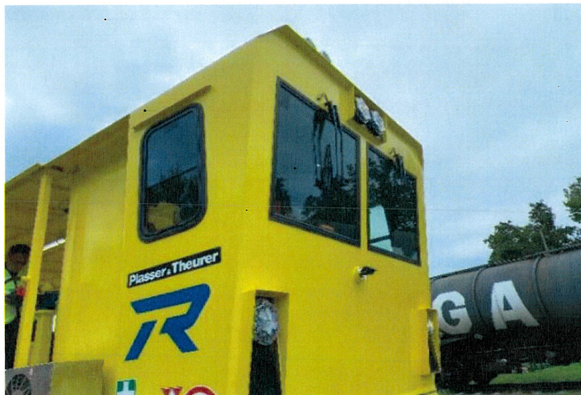
圖 111 軌道穩定車駕駛室配置電動雨刷
