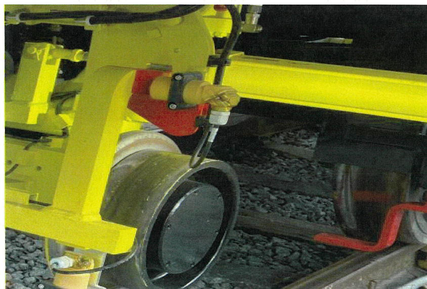
圖 104 軌道穩定車輔助排障器量測
