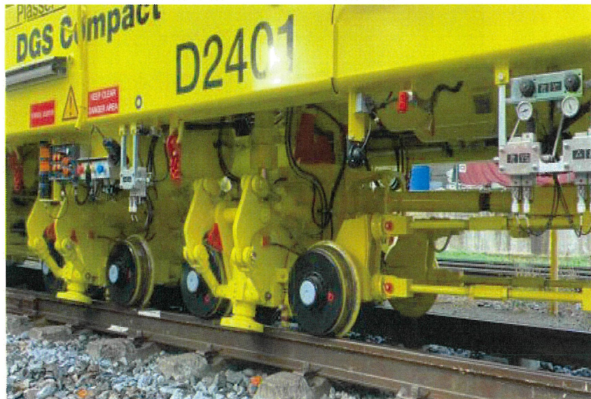
圖 119 軌道穩定車之穩定系統裝置測試
