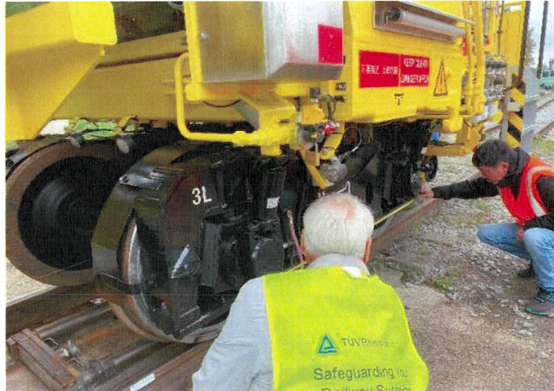
圖 70 中型砸道車轉向架車輪中心距離量測
