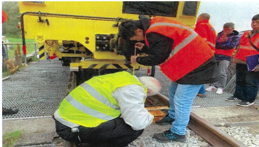
圖 68 中型砸道車連結器量測
