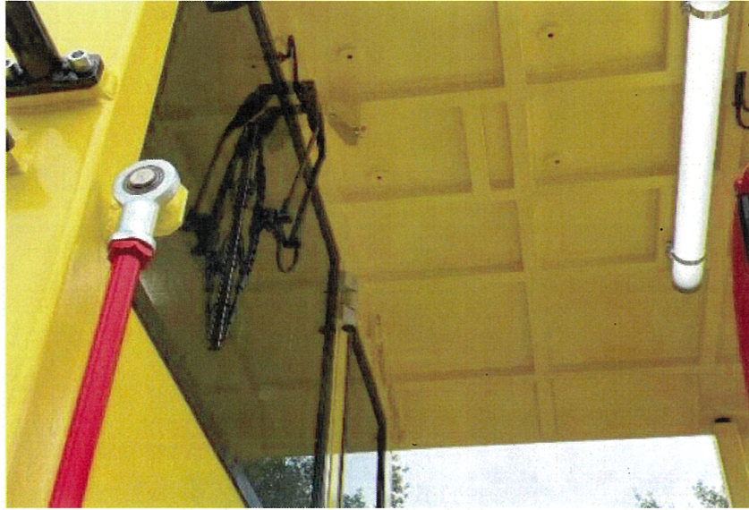
如圖 78 中型砸道車駕駛室配置電動雨刷
