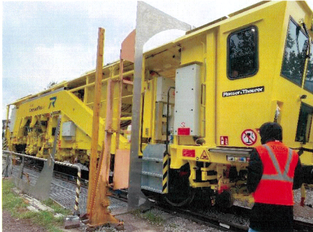
圖 73 中型砸道車車輛與縮小車輛界限測試
