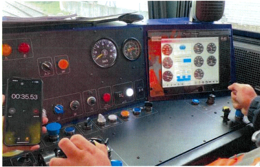
圖 83 中型砸道車按而不釋放警醒裝置紐測試
