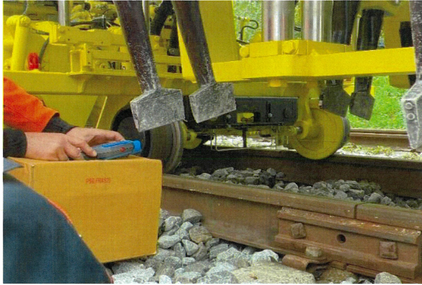
圖 88 中型砸道車振動頻率大於 35Hz 測試
