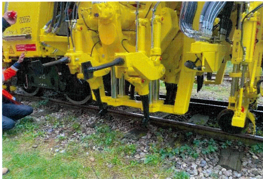
圖 86 中型砸道車單一砸道機構可橫向移動測試
