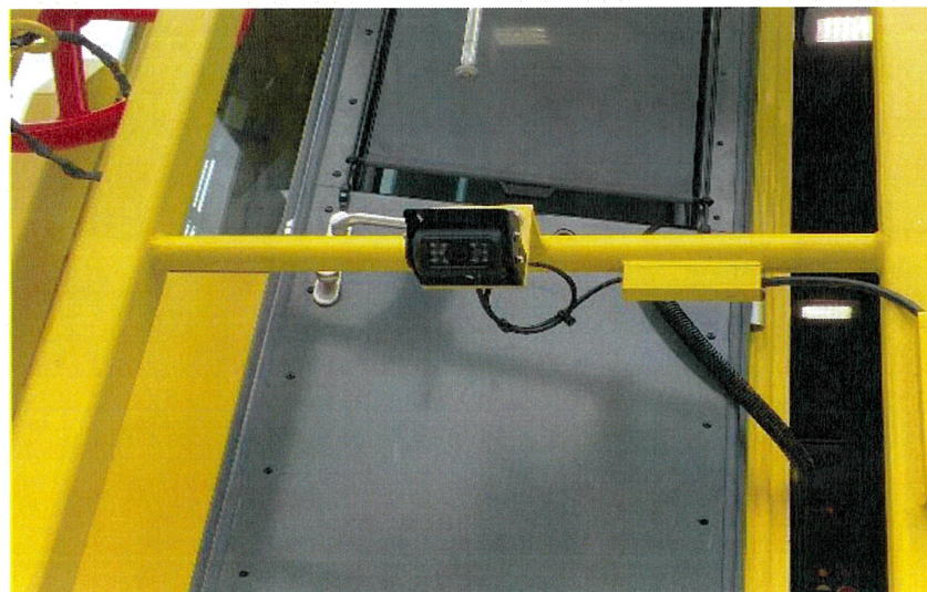
圖 84 中型砸道車攝影機鏡頭測試
