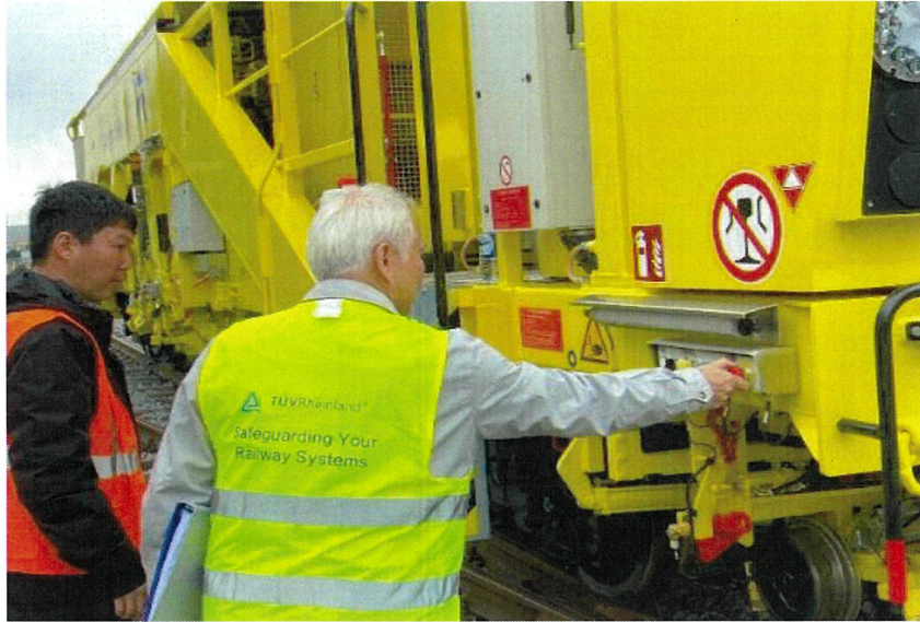
圖 85 中型砸道車緊急按鈕測試
