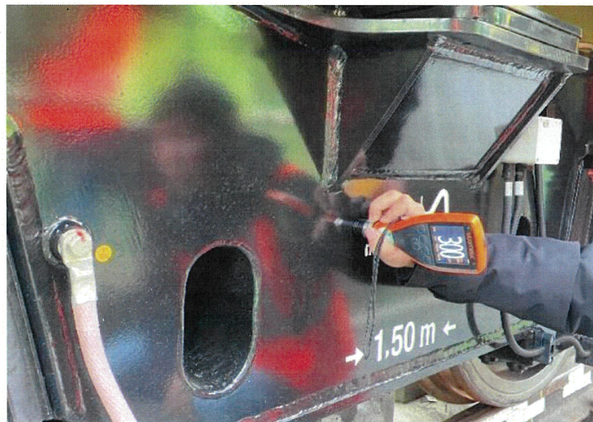
圖 65 中型砸道車塗裝膜厚測試
