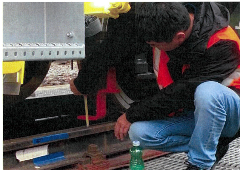
圖 71 中型砸道車輔助排障器量測
