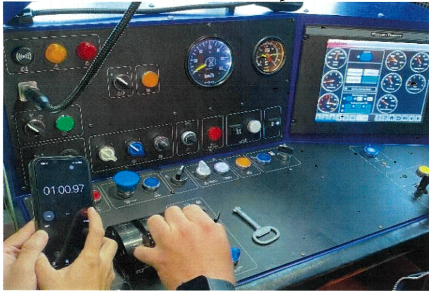
圖 81 中型砸道車連續行使 60 秒測試
