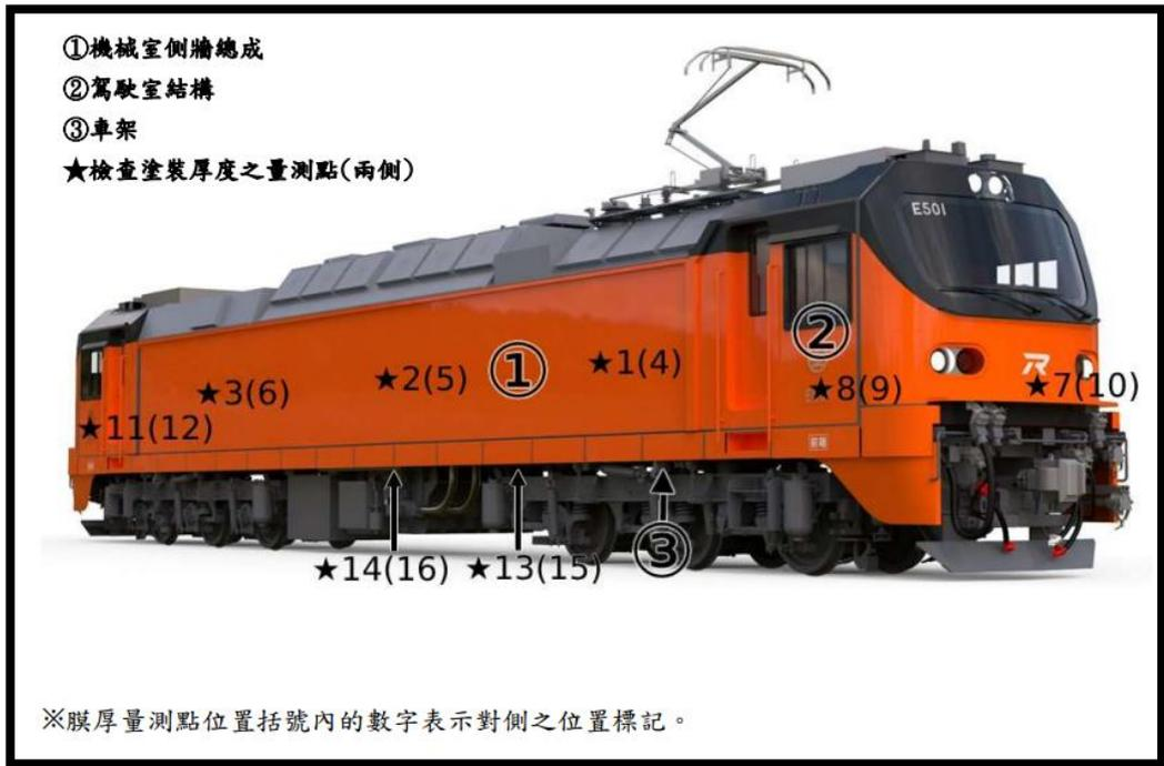
圖 3-6-4 油漆膜厚測量點示意圖
