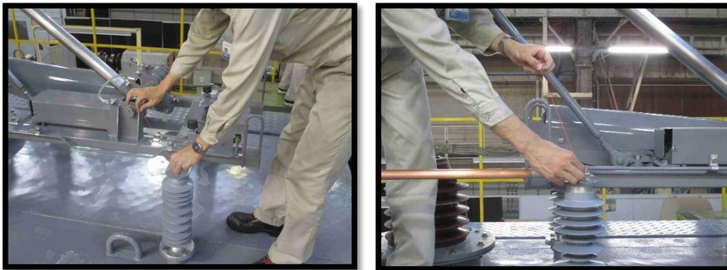
圖 3-4-2. 實際測量電氣間隙
