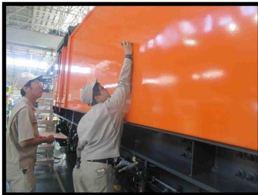
圖 3-6-5 機械室側牆油漆膜厚測量
