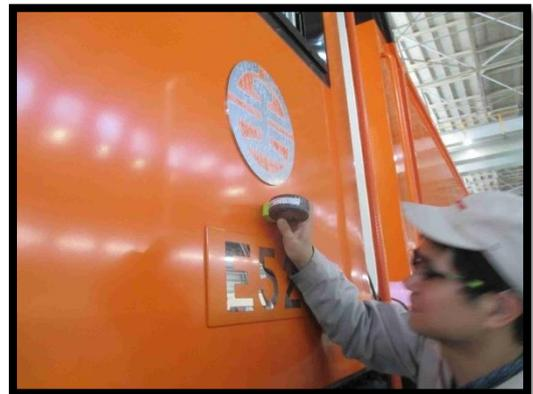
圖 3-6-6 駕駛室結構油漆膜厚測量
