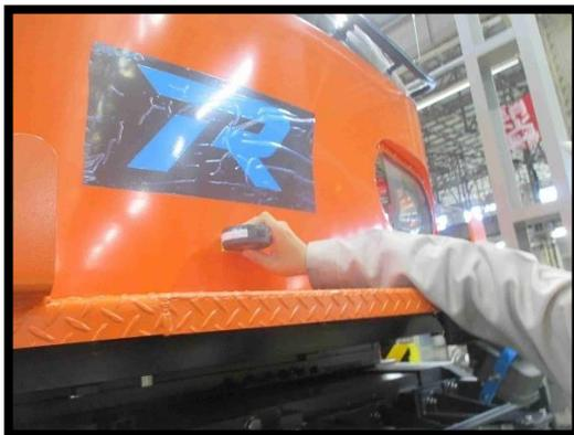
圖 3-6-7 駕駛室結構油漆膜厚測量
