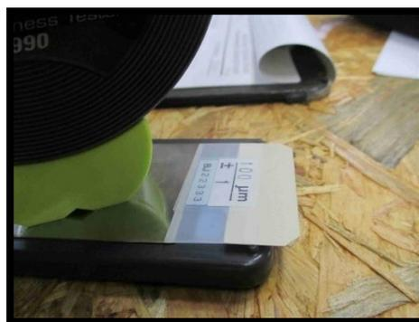
圖 3-6-2. 膜厚計用校正片
