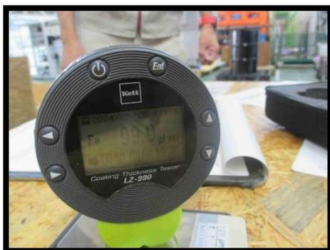
圖 3-6-1. 膜厚計符合校正數值
