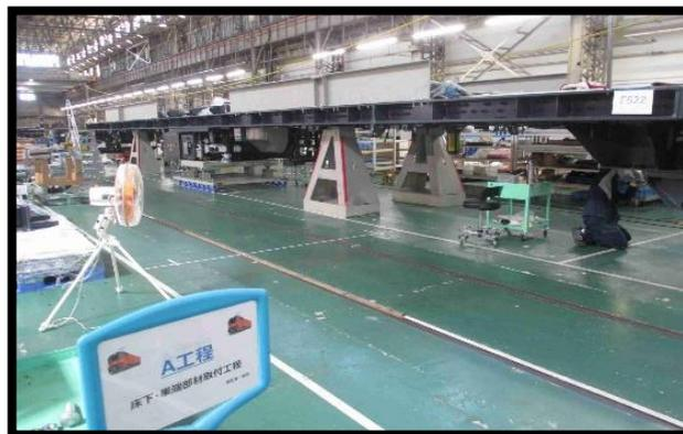
圖 3-1-3. 車架下設備安裝
