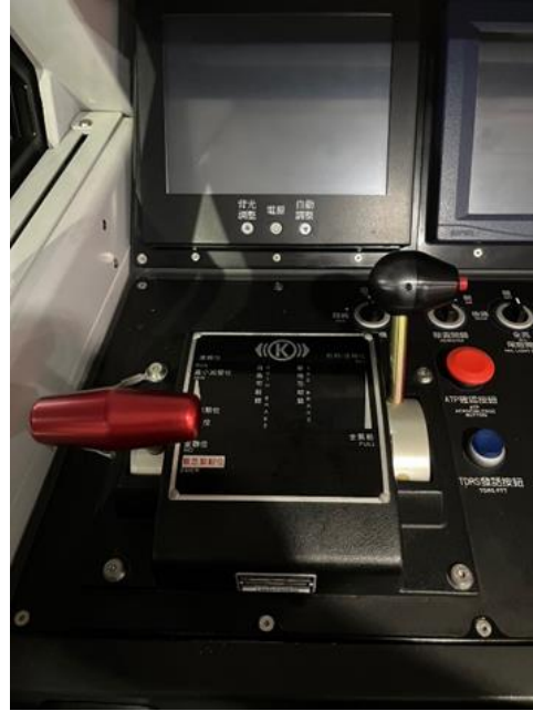
▲舊型柴電機車僅有最基礎的軔機（圖左），有較長的空走時間；R200 型柴電機車有電軔功能（圖右），能提供更強力的煞車。
