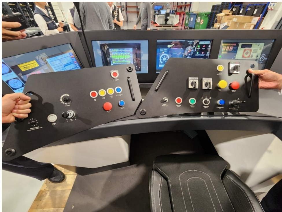
▲快拆模組拆裝，僅需三角鑰匙即可輕鬆卸下。
