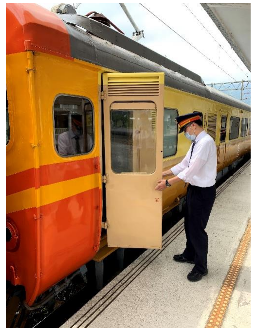
▲藍鈴鐵道所使用之車廂門為外推式（如圖左），與本公司同為英國製造的 EMU100 型駕駛室側門電聯車設計（如圖右）雷同。另因應當地冬季寒冷天氣，機車之蒸氣以管路送至車廂，提升車廂內溫度。
