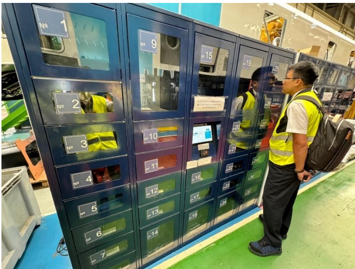
▲圖左：施泰德公司針對各工具進行控管，有條不紊地放在帶有編號的置物櫃中。圖右：耗材類工具以販賣機方式儲存，員工以識別證領取。
