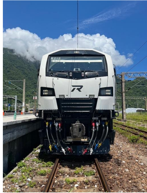
▲舊型柴電機車採用鹵素燈泡，容易燒壞、不耐用；R200 型柴電機車採用 LED 頭尾燈，更耐用及環保。
