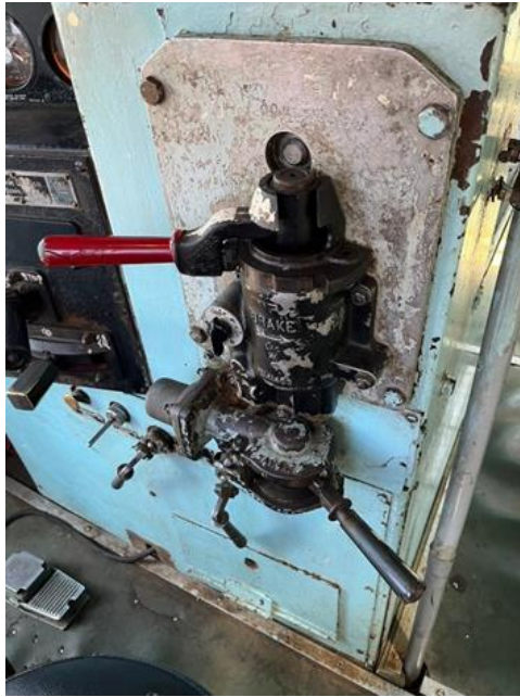
▲舊型柴電機車僅有最基礎的軔機（圖左），有較長的空走時間；R200 型柴電機車有電軔功能（圖右），能提供更強力的煞車。
