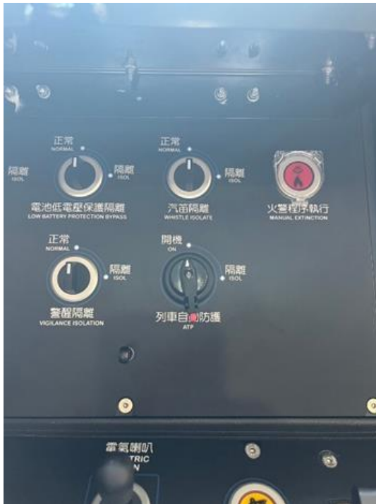
▲R200 型柴電機車除了裝設既有的各項安全保安系統如 ATP 及警覺裝置等，並已內建限速備援系統。
