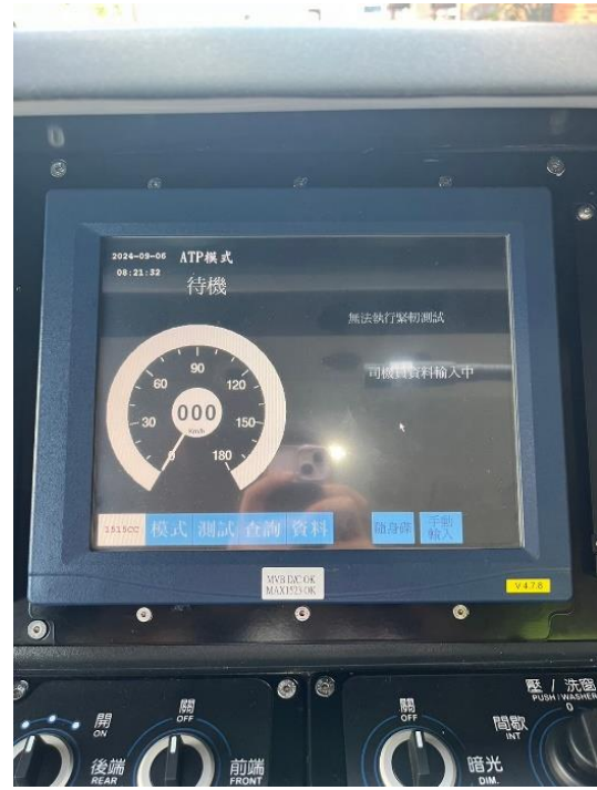
▲R200 型柴電機車除了裝設既有的各項安全保安系統如 ATP 及警覺裝置等，並已內建限速備援系統。
