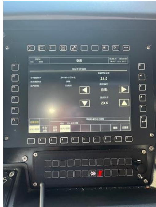
▲舊型柴電機車空調僅能開啟或關閉（圖左），且效果不佳；R200 型柴電機車配有恆溫空調（圖右），可在 LCMS 螢幕上依個人喜好設定溫度。
