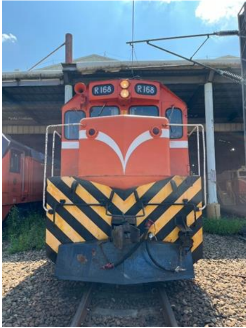
▲舊型柴電機車採用鹵素燈泡，容易燒壞、不耐用；R200 型柴電機車採用 LED 頭尾燈，更耐用及環保。
