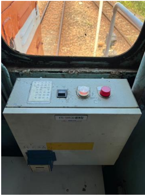
▲舊型柴電機車空調僅能開啟或關閉（圖左），且效果不佳；R200 型柴電機車配有恆溫空調（圖右），可在 LCMS 螢幕上依個人喜好設定溫度。
