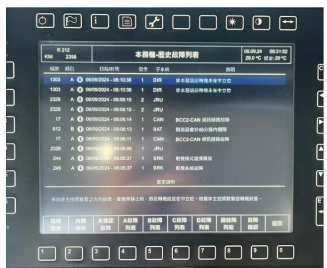
▲R200 型柴電機車之 LCMS 螢幕可以提供司機員非常豐富的資訊（圖左），可以明確看到機車運作狀態（包括油量、水溫、引擎轉速等），且機車有故障時，也可明確知道故障之狀態，並提供簡易故障排除方法。
