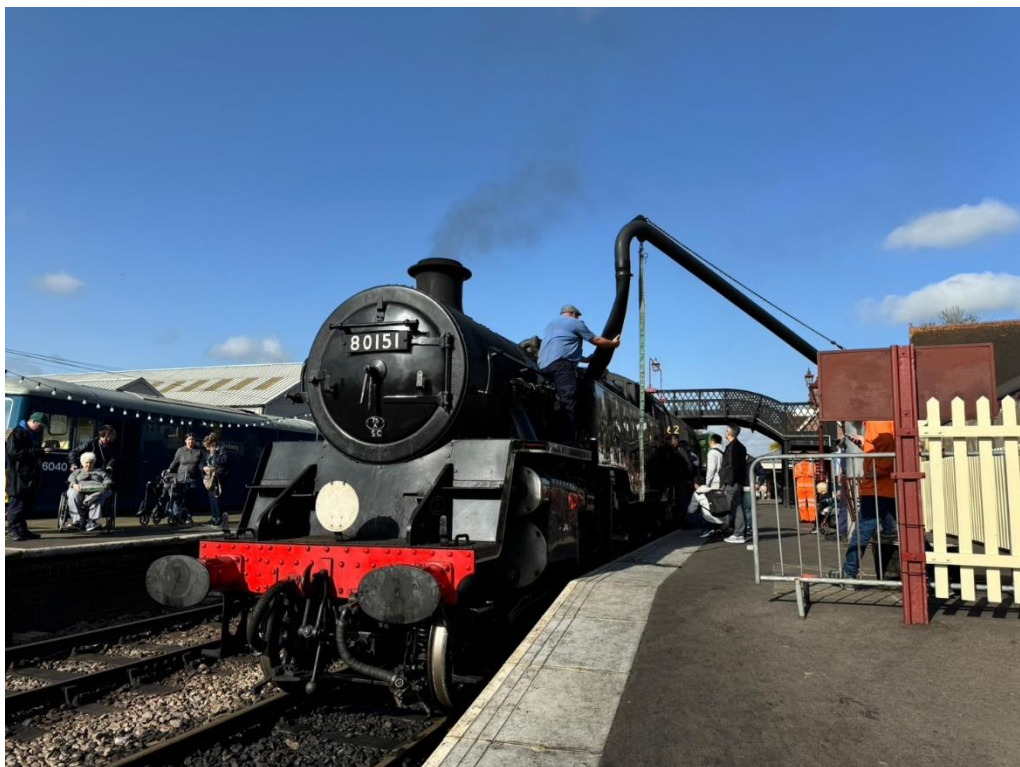
▲蒸汽機車 No.80151 於謝菲爾德公園（Sheffield Park）站執行加水作業。藍鈴鐵道仍保持使用「水鶴」為蒸汽機車加水，此景於臺鐵已絕跡。
