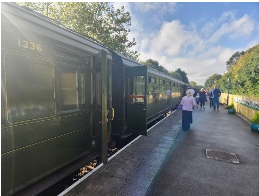
▲藍鈴鐵道所使用之車廂門為外推式（如圖左），與本公司同為英國製造的 EMU100 型駕駛室側門電聯車設計（如圖右）雷同。另因應當地冬季寒冷天氣，機車之蒸氣以管路送至車廂，提升車廂內溫度。
