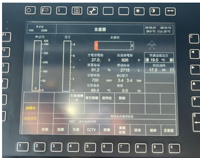
▲R200 型柴電機車之 LCMS 螢幕可以提供司機員非常豐富的資訊（圖左），可以明確看到機車運作狀態（包括油量、水溫、引擎轉速等），且機車有故障時，也可明確知道故障之狀態，並提供簡易故障排除方法。
