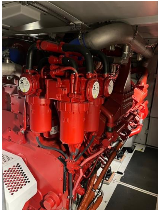
▲R200 型柴電機車採用康明斯 QSK60III B 型 4 行程引擎，提供高達 2700 匹馬力的動力，可牽引的重量大幅提升。
