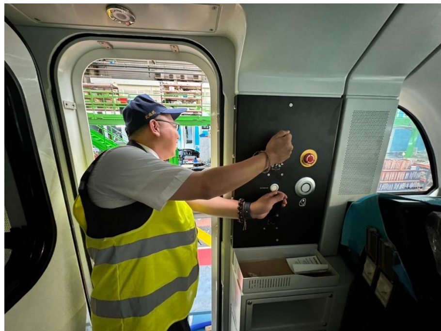
▲EURO9000 型亦可於駕駛室側邊操作臺操作列車，讓司機員的視野不受限。
