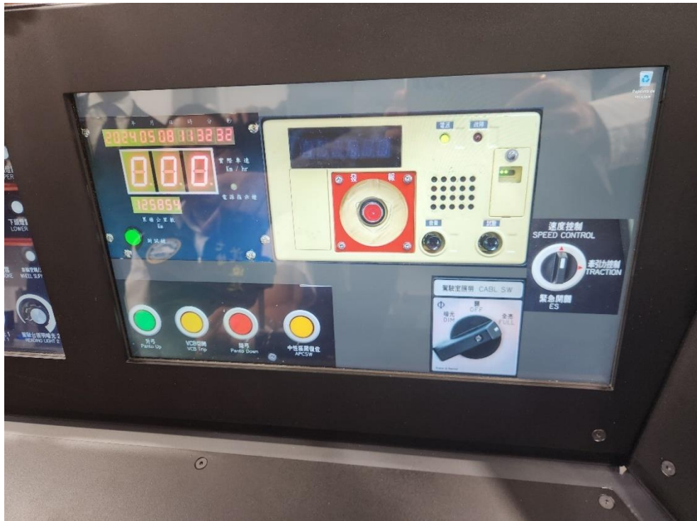
▲駕駛模擬機將車上設備扁平化放入螢幕中，受訓者操作時可模擬列車真實情形，大大減少所需空間。
