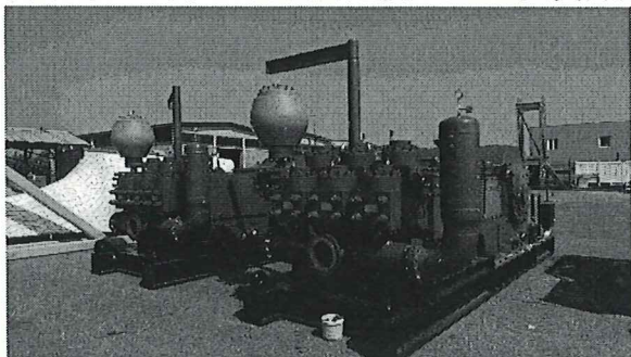
圖 25. 等候連接至泥漿設備之泥泵(共2台)。
