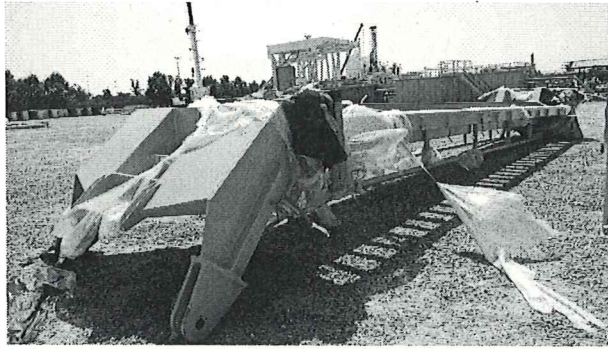
圖 37. 液壓貓道等候安裝至鑽井平台。
