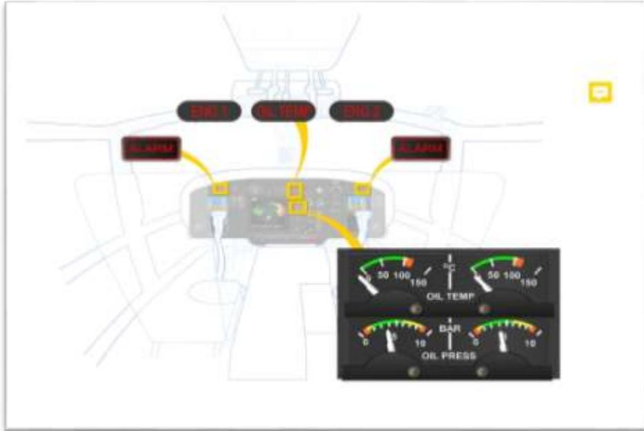
圖 3-6 發動機滑油系統顯示儀表
