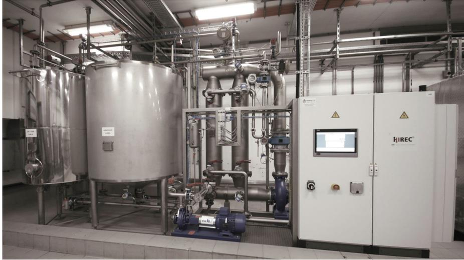
圖33：HIREC®超過濾系統單元
