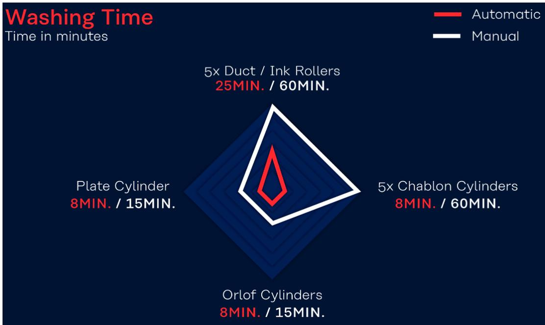
圖16：自動化及手工清洗時間對照
