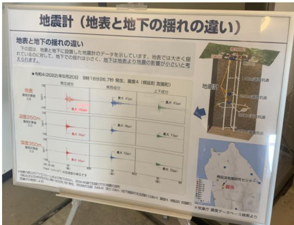
圖 16：地震儀於不同測定位置記錄地震振動之差異說明
