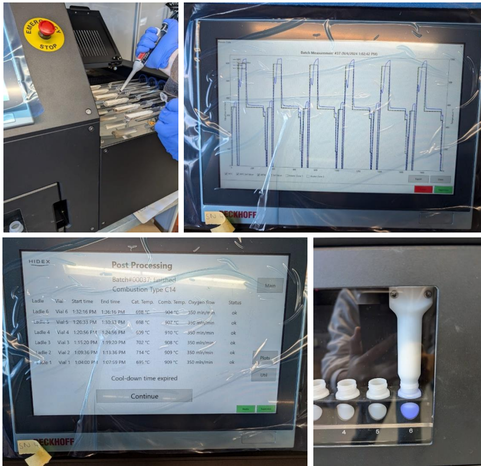
圖 13-16、氧化燃燒器操作
