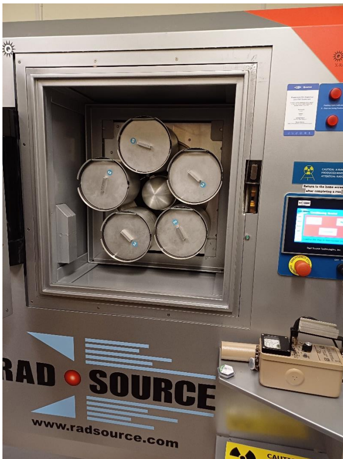
圖 4. 商業運轉之檢疫 X 光設備
