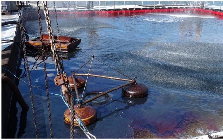
圖 3-14 使用刷式、堰式汲油器進行抽油作業
