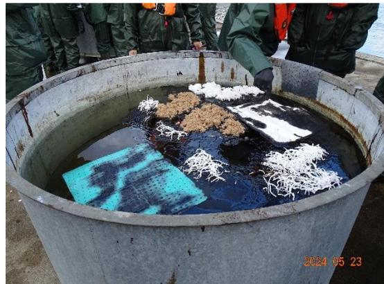
圖 3-11 不同類型的吸附材料的吸附效果
