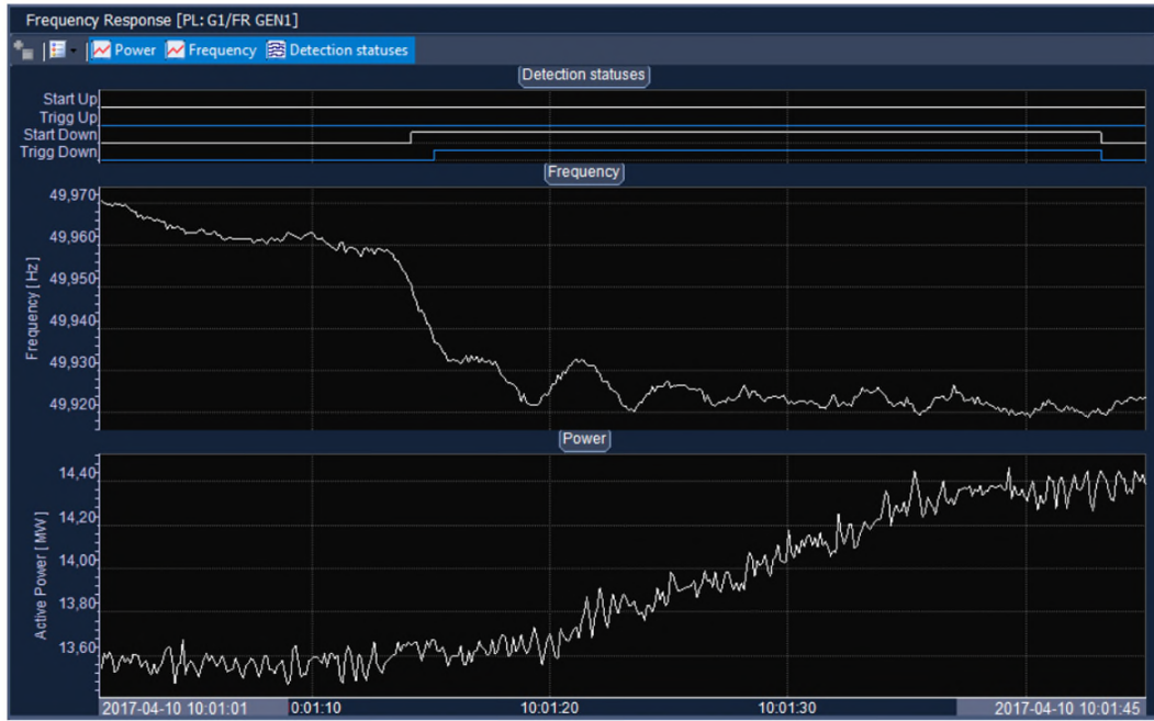
圖 11 ENTSO-E 頻率變化時發電機的頻率響應
