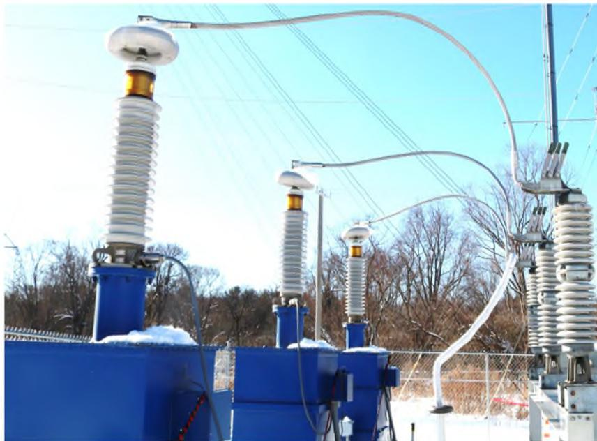
圖 4.11 變電設備過電壓實驗場(EPRI 夏洛特研究中心)
