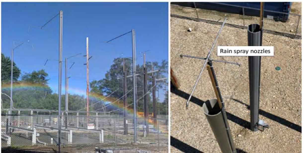
圖 4.9 變電設備雨霧鏽蝕實驗場(EPRI 夏洛特研究中心)
