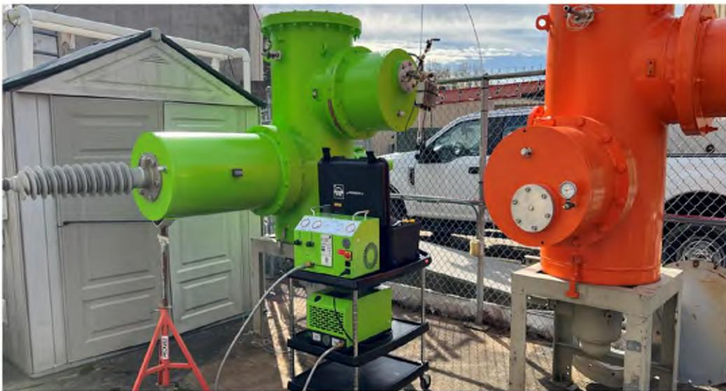
圖 4.6 GIS 之 SF<sub>6</sub> 氣體替換研究(EPRI 夏洛特研究中心)
