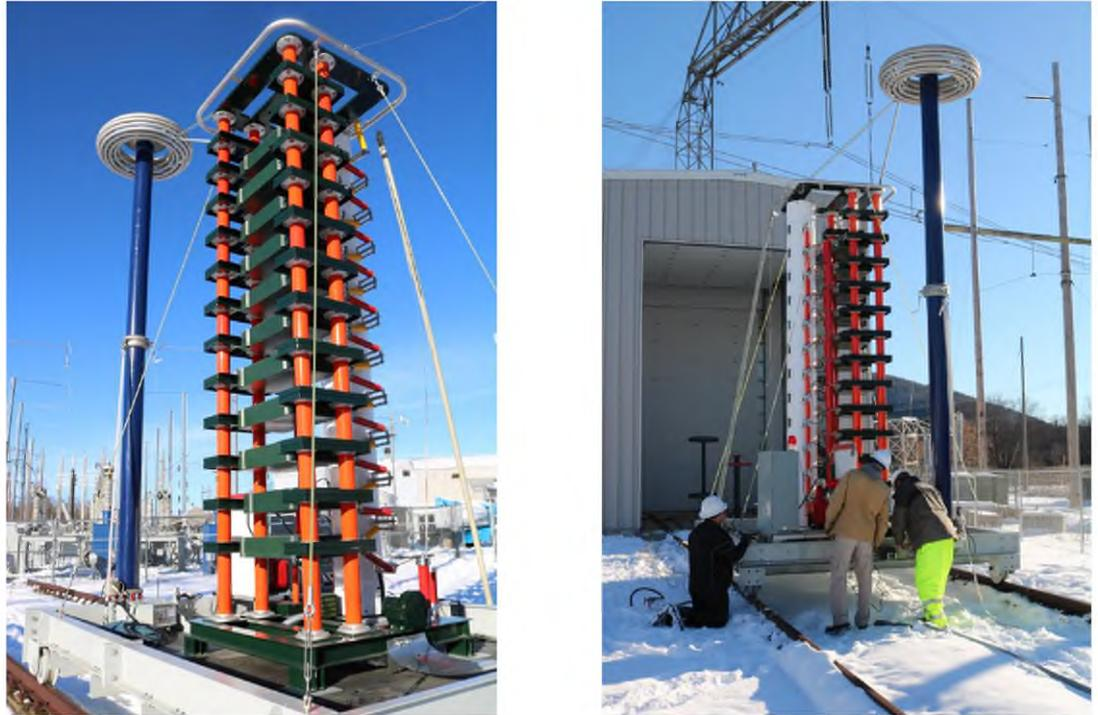
圖 4.10 變電設備雷擊脈衝實驗場(EPRI 夏洛特研究中心)
